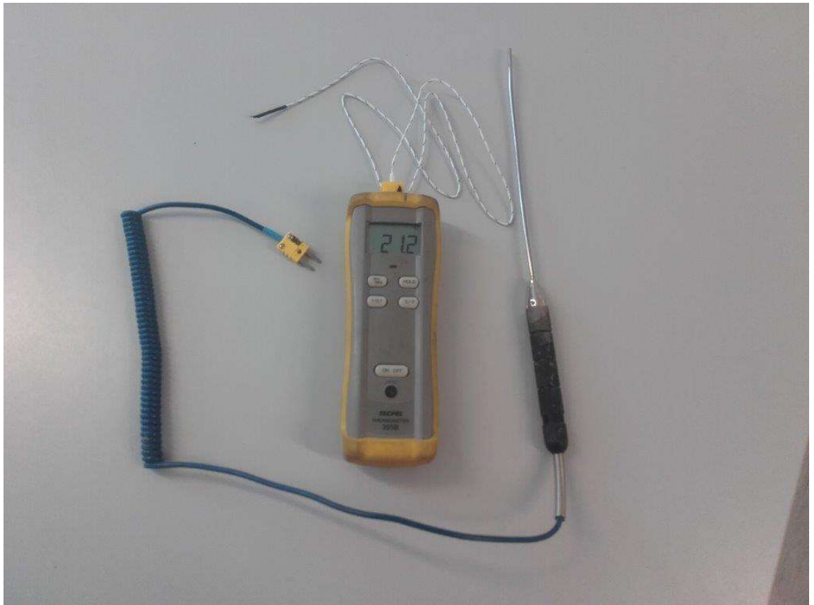
Kuva 12. K-anturi ja lämpömittari (Kuva: Miika Kyllönen)
