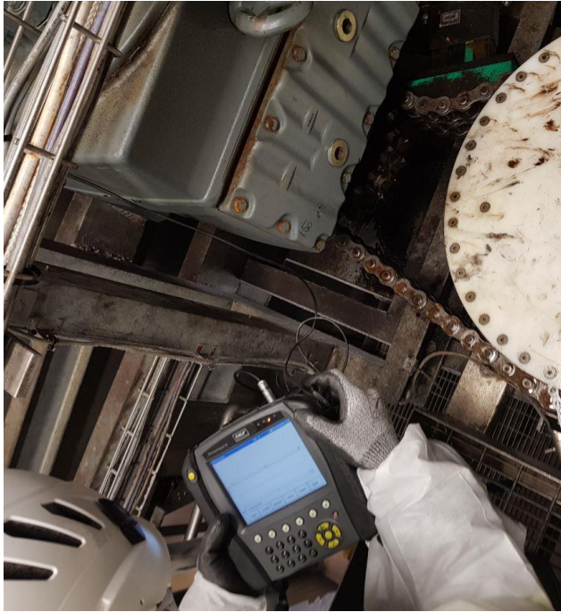
Kuva 17. Kunnonvalvontamittaus jäähdytyskuljettimen moottorivaihteistopakelistä.
