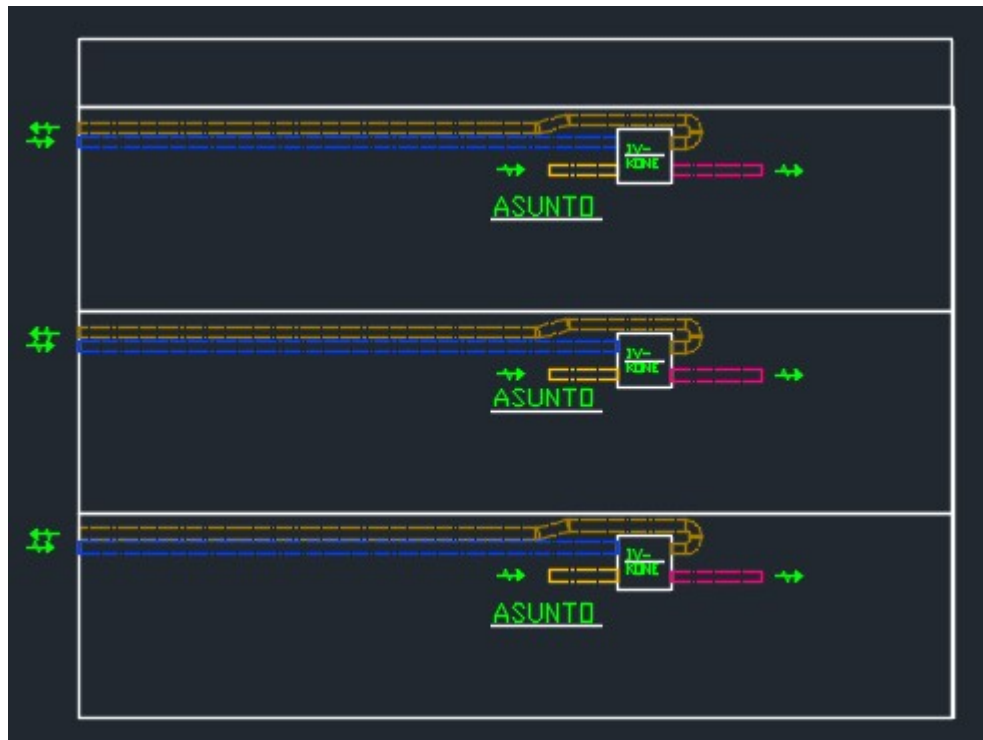
Kuva 6. Keskitetty ilmanvaihto, jossa ilmanotto ja ulospuhallus tapahtuvat seinältä.
