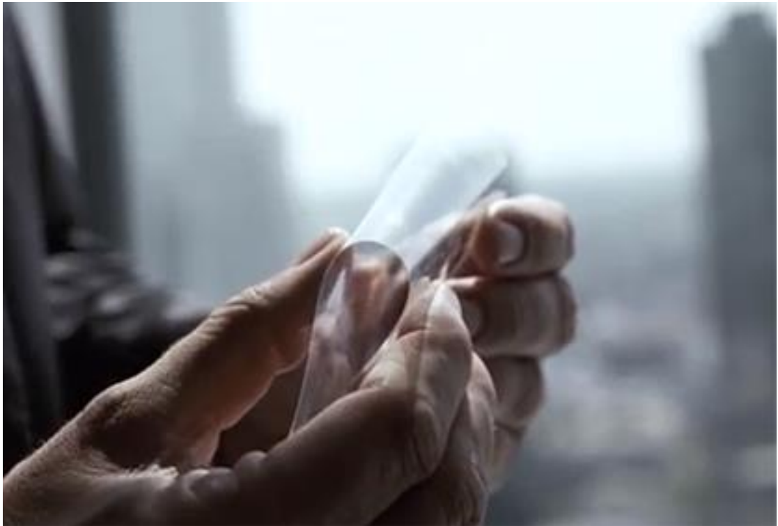
Kuva 3. Ultraohutta lasia, joka on ohuimmillaan myös taipuisaa [14].
