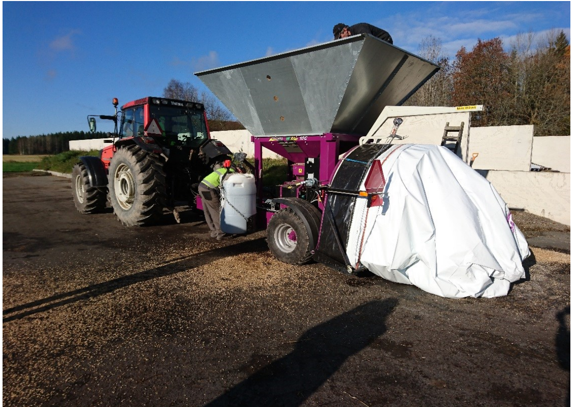
Kuva 8. Urakoitsija Mustialan tutkimus- ja opetusmaatilalla. Murskaukseen käytettiin W-Max 10 Contractoria, joka on urakointikäyttöön suunnattu, tuubinpakkainlaitteella varustettu malli. (Tuominen 2017)
