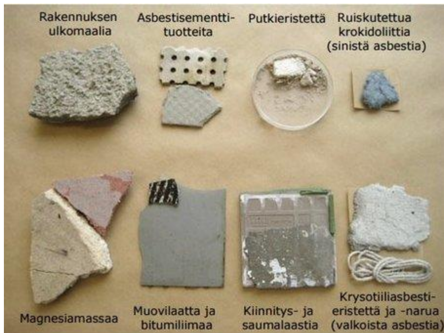
Kuva 9. Asbestia sisältäviä rakennusmateriaaleja (Lähde RT 18-11246, 3).
