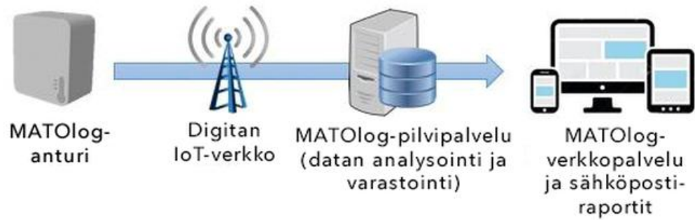
Kuvio 16. MATOlog mittauslaitteen toimintaperiaate (Mato Engineering 2018)
