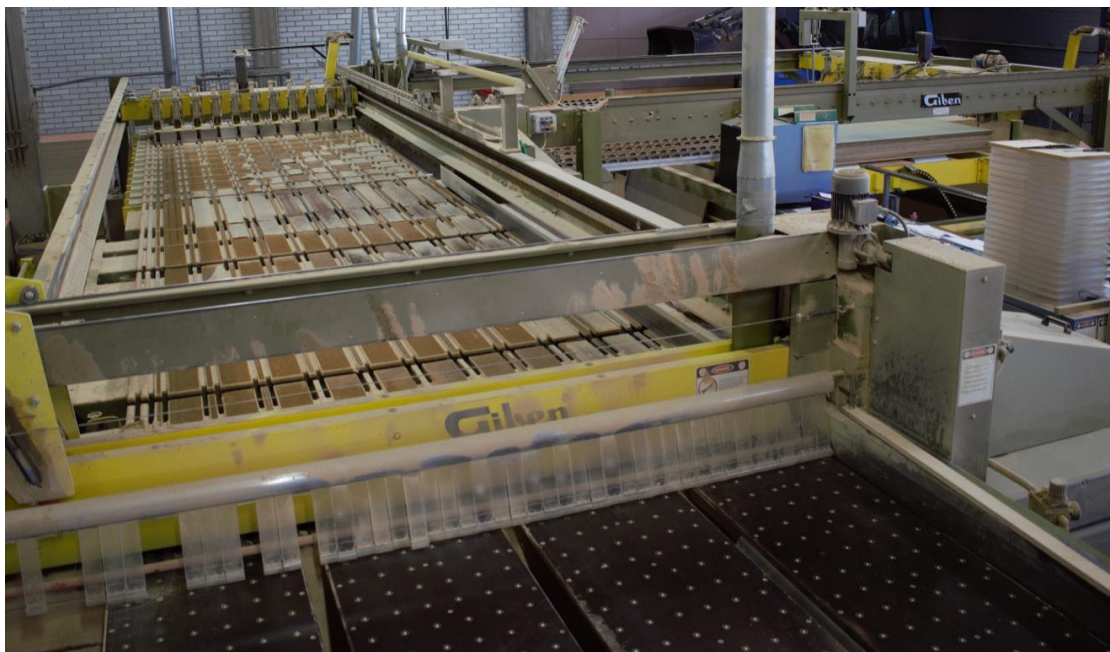
KUVA 4. Levynsahassa levynippu sahataan osiin pituus- ja leveysuunnassa. Etualalla näkyy valmiiden levyjen vastaanottopöytä.
