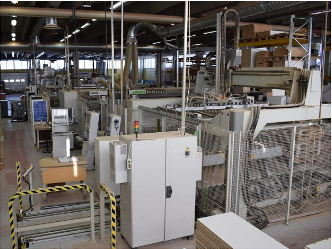
KUVA 6. Niemen Tehtaat Oy:ssä suurin osa kappaleista porataan CNC- ohjatulla konelinjalla.
