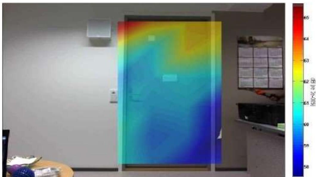
D115, ovi. Desibelivaihteluväli: 58-65 dB. Oven kahvanpuoleisessa ylänurkassa havaittavissa merkittävää vuotoa.
