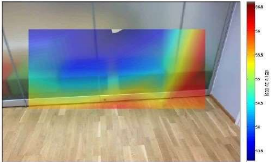
E166, etummainen lasiväliseinä oikealta alhaalta. Desibelivaihteluväli: 53,5-56,5 dB. Seinän oikeassa alanurkassa havaittavissa vuotoa.
