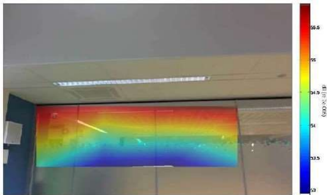
E166, perimmäinen lasiväliseinä vasemmalta ylhäältä. Desibelivaihteluväli: 53-56,5 dB. Seinän yläreunassa havaittavissa pienehköä vuotoa.
