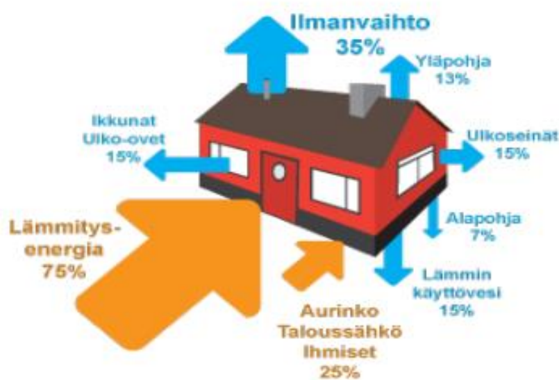
KUVA 7. Omakotitalon lämpöhäviöiden jakauma. (Puuinfo. 2013)
