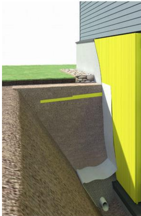
KUVA 12. Finnfoam CW-300 eriste asennettuna perusmuurirakenteeseen. (Finnfoam. 2018)
