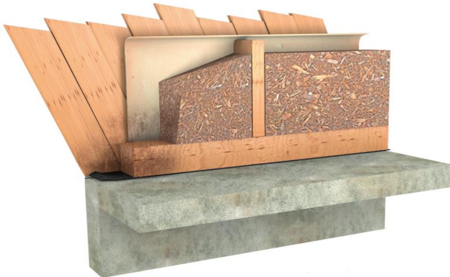
Kuvio 3. Purueristeisen ulkoseinän tyypillinen rakenne. /10/
