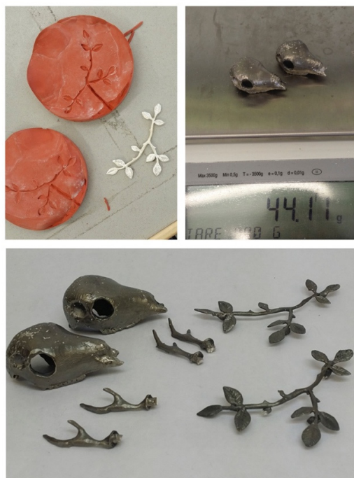
Kuva 63. Vulkanoitu kumimuotti köynnöspinnin koristeosasta sekä valussa toistetut kappaleet (Laura Turkulainen, 2018.)
