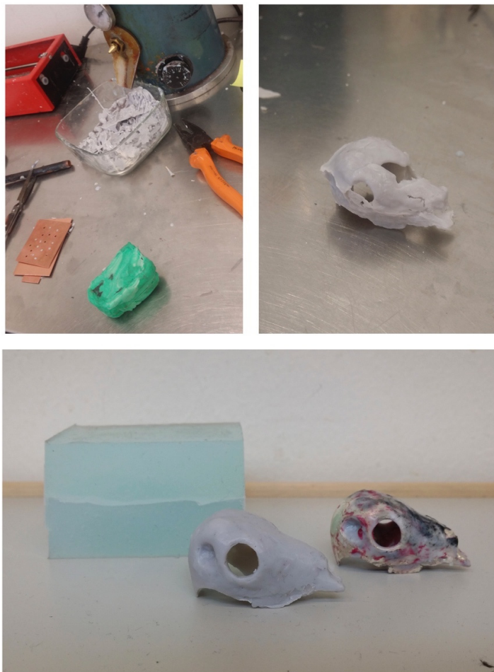
Kuva 62. Muotin ottoa omatekemälläni silikonimuotilla sekä nestemäisestä silikonista valmistetulla muotilla (Laura Turkulainen, 2018.)
