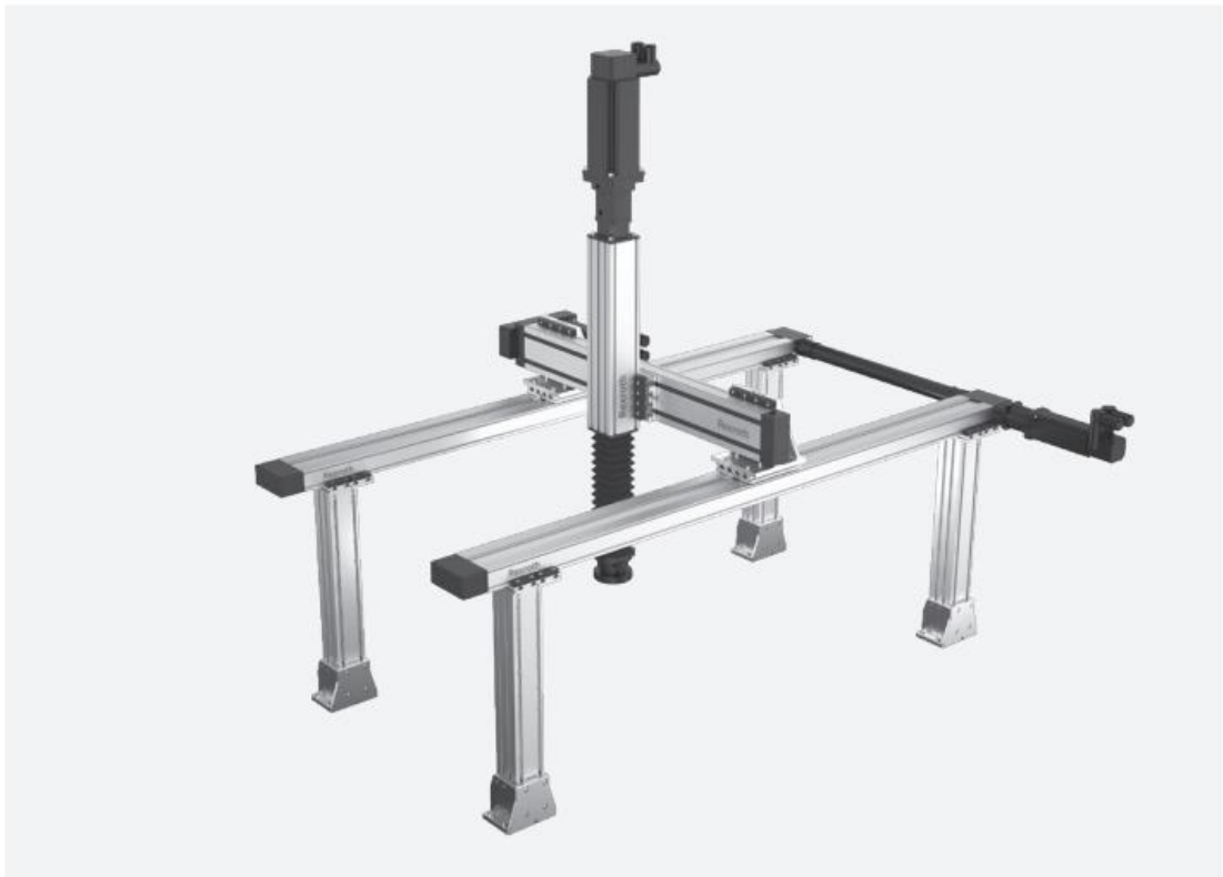
Kuva 14: Bosch Rexrothin lineaariakseleista koottu XYZ-robotti
