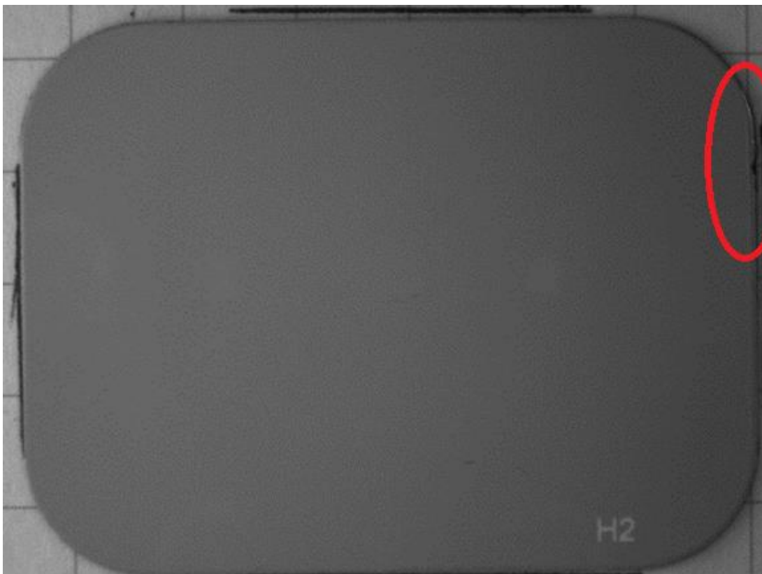
Kuva 13: Reunavirhekuvalevy, kuva otettu koaksiaalivalon kanssa. Virhe on punaisen ovaalin sisäpuolella
