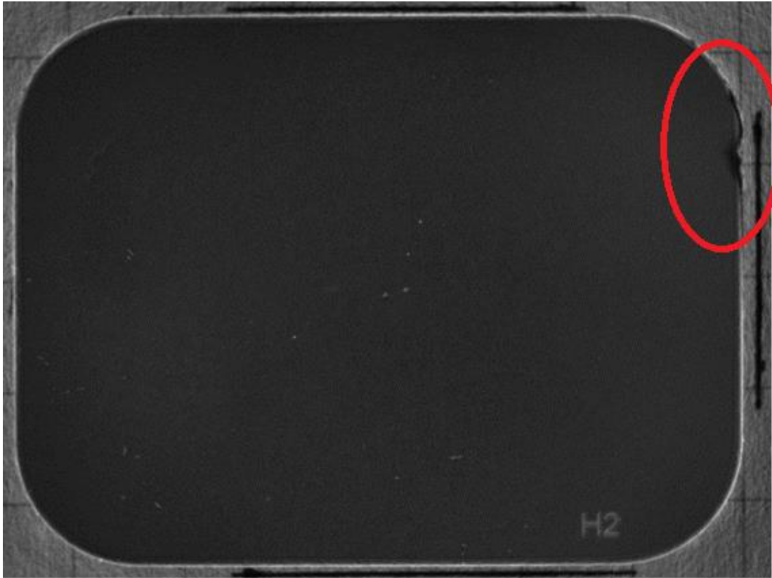
Kuva 12: Reunavirhekuvalevy, kuva otettu ympyrävalon kanssa. Virhe on punaisen ovaalin sisällä
