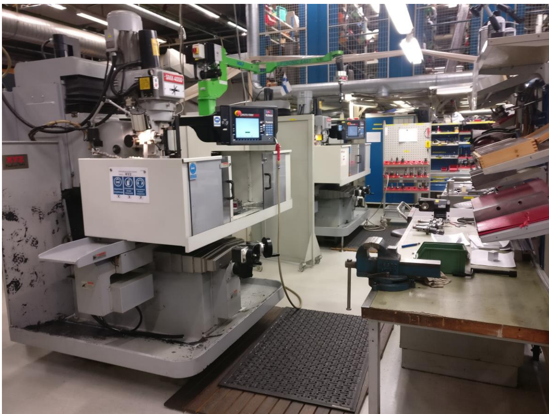
Kuva 17: SMX 4000 3-akselinen ohjelmoitava jyrsinkone
