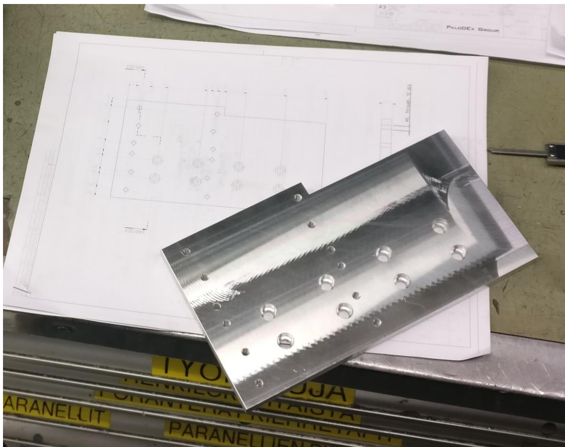
Kuva 18: X- ja Y-akselin väliin tuleva sovitinpala koneistettu SMX 4000 -jyrsimellä
