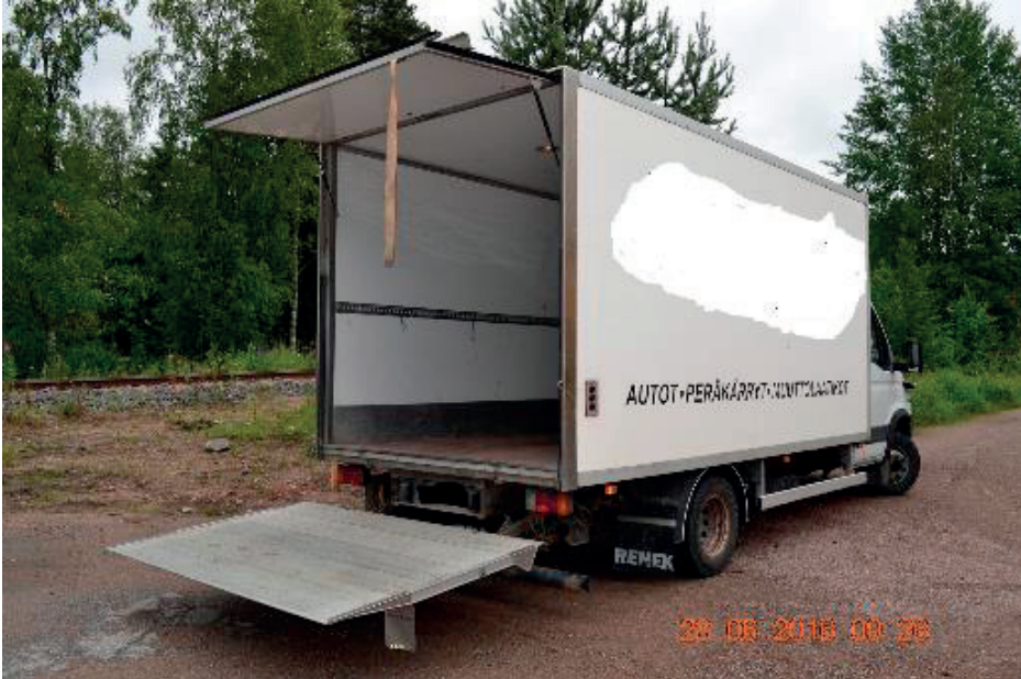
Kuva 4. Auki asennossa oleva perälautanostin. (ABC autovuokraamo 2018).
