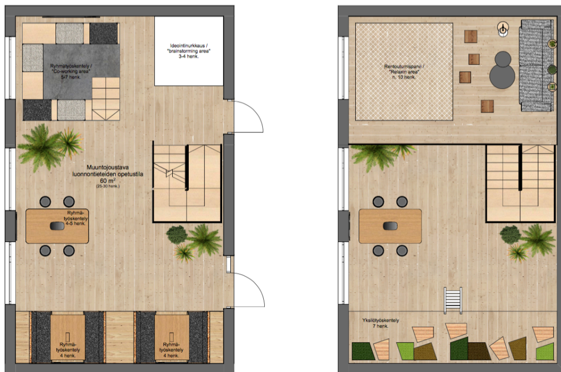
Kuva 19: Konseptisuunnitelmaa hahmottava muuntojoustavan luonnontieteiden opetustilan kalustepohjakuva SIS-110. Kuvassa vasemmalla on suunnitelman 1. kerros ja oikealla 2. kerros, joka koostuu parvista tilan molemmissa päädyissä. Kuva ei mittakaavassa. (Archicad-opiskelijaversio, Graphisoft)
