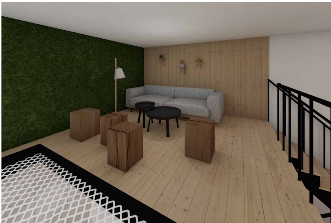
Kuva 16: 3D-visualisointikuva. Kuvassa on esitetty konseptisuunnitelman materiaali- ja kalustevalintoja. Alhaalla kuvan vasemmassa reunassa on parven lattiaan kiinnitetty valkoinen riippuverkko.
