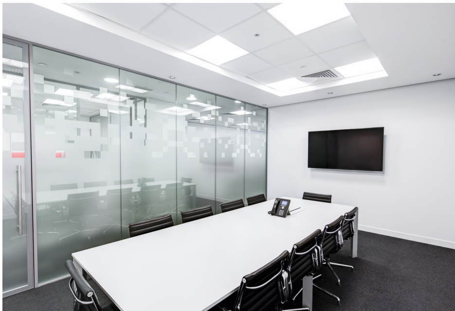
Kuva 4: Neuvotteluhuone, jossa käytetty värilämpötilaltaan n. 5000K valaisimia. (pixabay.com, Meeting room. 2015).
