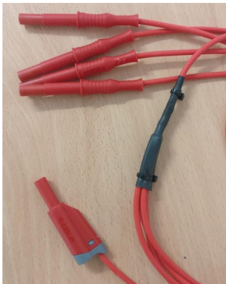
Kuva 11. Eristysresistanssi mittauksen mittapää. (Sainio, 2018).
