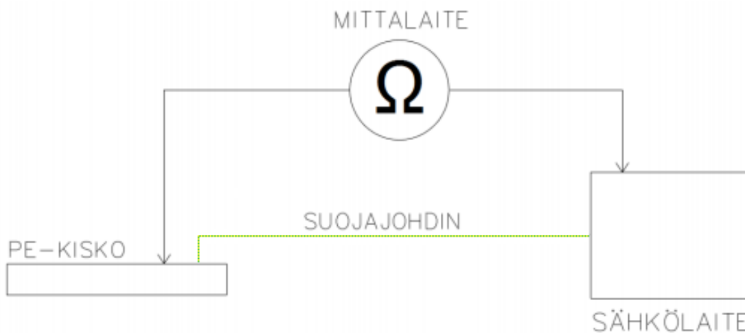
Kuva 1. Suojajohtimen jatkuvuuden mittauskytkentä. (Tiainen, 2017).
