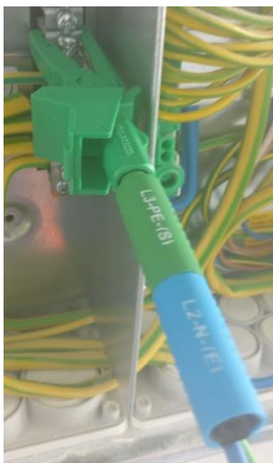
Kuva 12. Eristysresistanssimittauksen mittauskytkennän osa. (Sainio, 2018).
