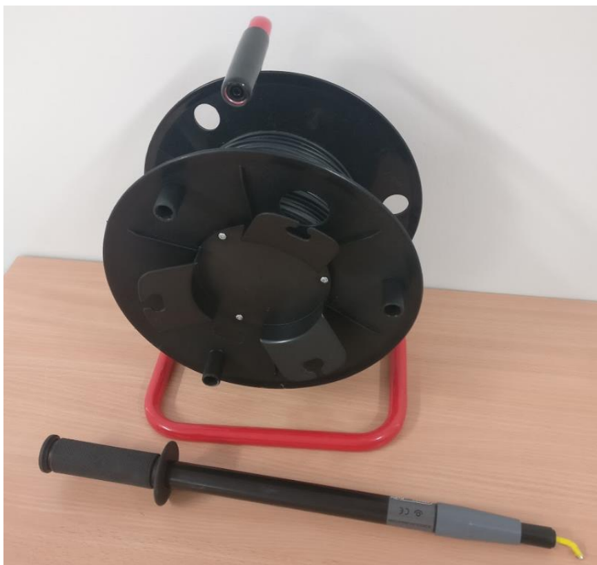
Kuva 13. Suojajohtimen jatkuvuuden mittapää ja apujohdin. (Sainio, 2018).
