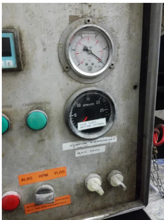
Kuva 12. Mustalla pohjalla oleva kierroslukumittari ja valkoiset kytkimet
