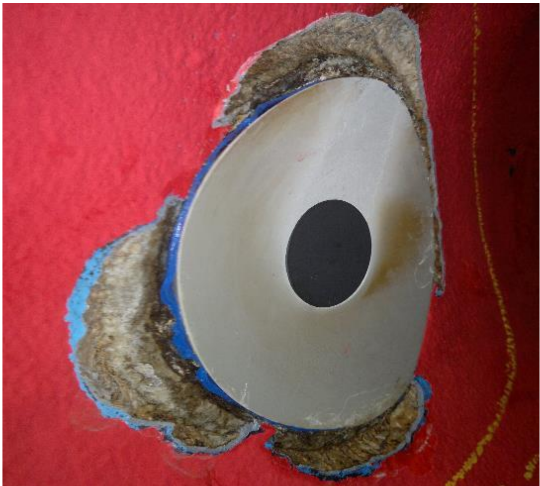
Kuva 4. Ylisuojauksen seurauksena syntynyt syöpymä. (Tanttu s.a.)
