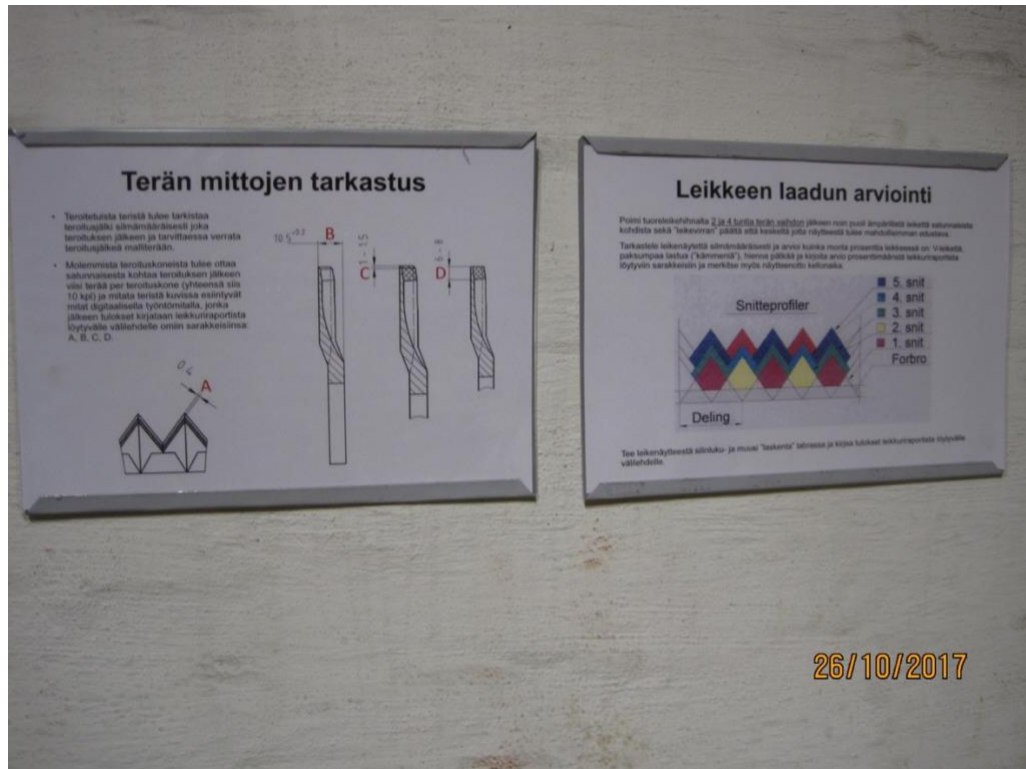
Kuva 4. Ohjetaulut. Terien mittojen tarkastus ja leikkeen laadun arviointi. (Putsch-laitemanuaali.)
