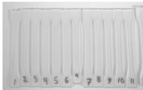
Kuva 2b: NW3052D uudelleen pelletöidyttä materiaalista (erä C) valetut vetosauvat klo 9.4. Työstössä 50 min aikana valmistui 70g:sta polymeeriä 11 kehvollista vetosauvaa. #12b ja #13c jäivät muuttin kiinni ja väänntyivät käsin muotista poistettaessa.
