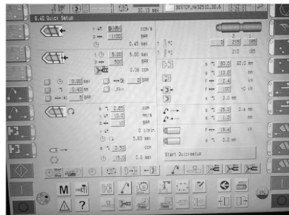
Kuva 4b: Lämpö ei riittänyt ja 10 min kuluttua t2=215°C ja hopperin kiertoa kuristettiin lisää.
