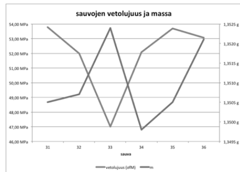
Kuva 1: 12,3% TCP seostettu NW3052D RV: 18.8.17 ext: 17.8.17 erä: F vetolujuus 18.9.17 ISO 527-2/1BA/L, menetelmä A, 1mm/min mukaisesti määritely venymä-rasitus kuvaajat.
