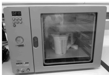
Kuva 5. Pelletit laitettiin kuivumaan 30°C tyhjiöuuniin klo 16:00 avonaisissa 1/2L minigrp-pusseissa.
