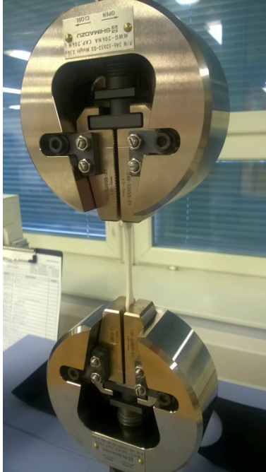
Kuva 32. Koekappaleen asettelu vetolujuuden määrittelyssä. Pitimien etäisyys mitattiin työntömitalla ennen testin alkua.
