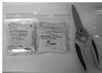
Kuva 2: Taivutettujen HMW (D-erästä) valettujen sauvojen alaosa leikattiin Inc.co -saksilla 1-2 mm paksuksi silpuksi. Sauvat 2-8 ruiskuvalettiin temperoimattomalla muotilla 28.8.17 ja 65-72 40 °C temeproidulla muotilla 11.9.17.
