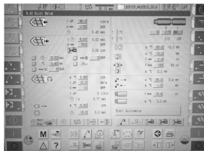
Kuva 4d: Lämpö ei riittänyt ja 10 min edellisestä t2=220 °C. Tuloksena kanava tappeja ja vajaita kappaleita - lämmöt alhaiset vaikka 15 s odotus palstoitettiin aloittamassa. Ruuvi vetäytyy hitaasti ja jäi jummin.
