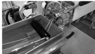
Kuva 2b: Ekstrudaatin jäähdäys vesihautteessa noin 7 cm matkalla suuttimen jälkeen.
