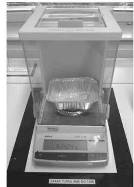
Kuva 2: Mettler-Toledo AB204-S analyysi vaaka, jota käytettiin yleispunnituksiin sekä käytetty keräysastia.
