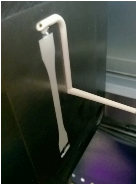
Kuva 26. Käytetty 1-pesäisen muotin takakappale ja ruiskuvalettu vetosauva ennen kappaleen poistamista muotista.
