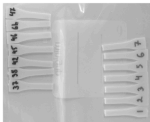
Kuva 1: Taivutettujen TCP sauvojen (F-osa) alaosa leikattiin Inc.co -saksilla 1-2 mm paksuksi silpuksi. Sauvat 1-7 oli valmistettu 29°C temperoidulla muotilla ja 37, 38, 42, 45, 47 ja 49 oli valettu 40 °C muotilla.
