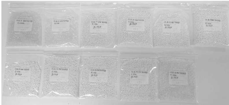
Kuva 8: Pelletisädyt erät (11) C-M 1/2 L minigripussissa ennen vakuumiunin (35 °C) kuivumaanlaittoa klo 16.10. Väri vaihtelee TCP pitoisuuden mukaan.
