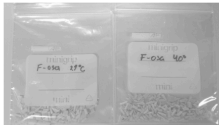
Kuva 1: Taivutettujen TCP sauvojen (F-osa) alaosa leikattiin Inc.co -saksilla 1-2 mm paksuksi silpuksi. Sauvat 1-7 oli valmistettu 29°C temperoidulla muotilla ja 37, 38, 42, 45, 47 ja 49 oli valettu 40 °C muotilla.
