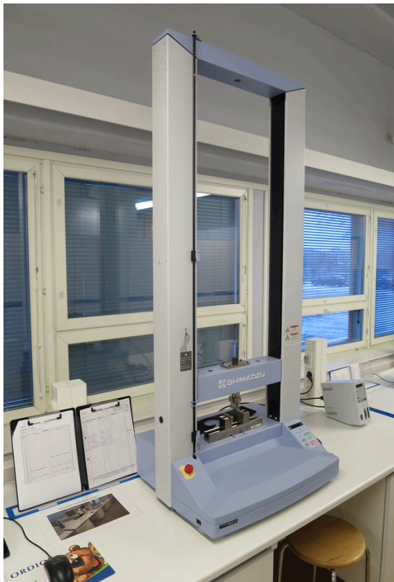
Kuva 27. Käytetty mekaanisen karakterisoinnin laitteisto Shimadzu AGS-X taivutus-koeyrjestelyssä.
