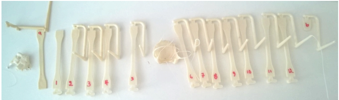
Kuva 30. 8,6% LMW seostettu NW 3052D, A-erän pelleiteistä ruiskuvaluttu vetosauvat. Sauva a plastisoitui muottiin ja sauva b jäi vajaaksi ruiskuvalulaitteen tukkeutuessa.
