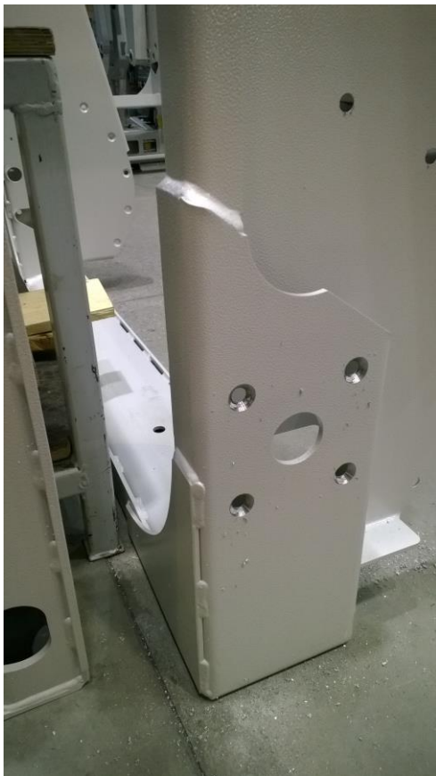
KUVA 11. Hissin vivun kiinnitysreiät vaativat aina reikien putsaamista liiallisesta maalista.
