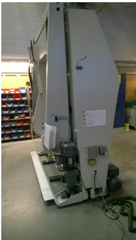
KUVA 10. Hissin pystyyn nostamisen jälkeen siihen tehdään sähkökytkennät ja viimeis- telyä
