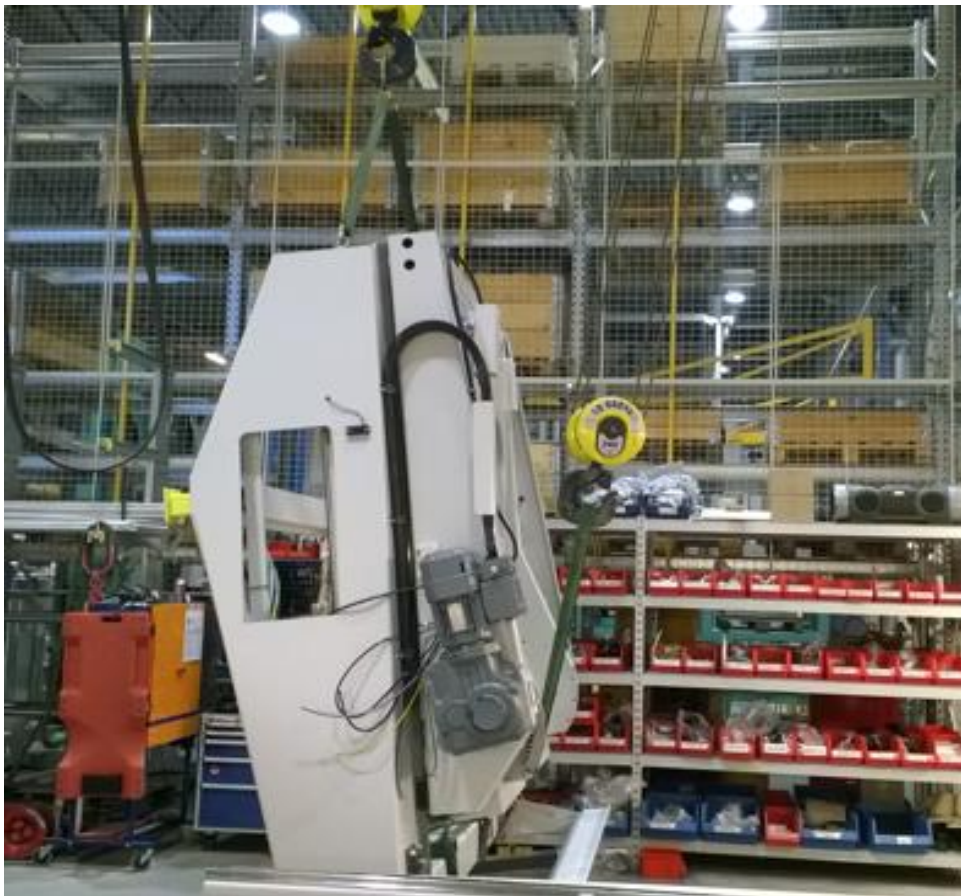
KUVA 12. Rungon kääntäminen nosturin avulla paikkakokoonpanossa
