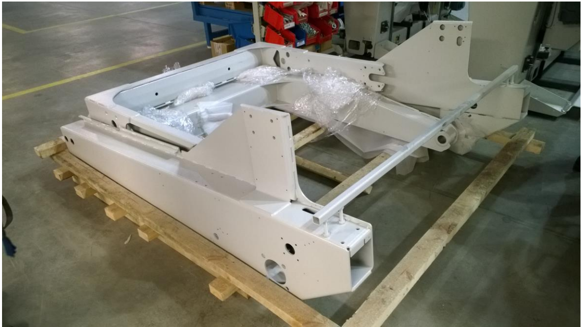
KUVA 15. Vivut ja nostokelkka samalla lavalla paikkakokoonpanossa
