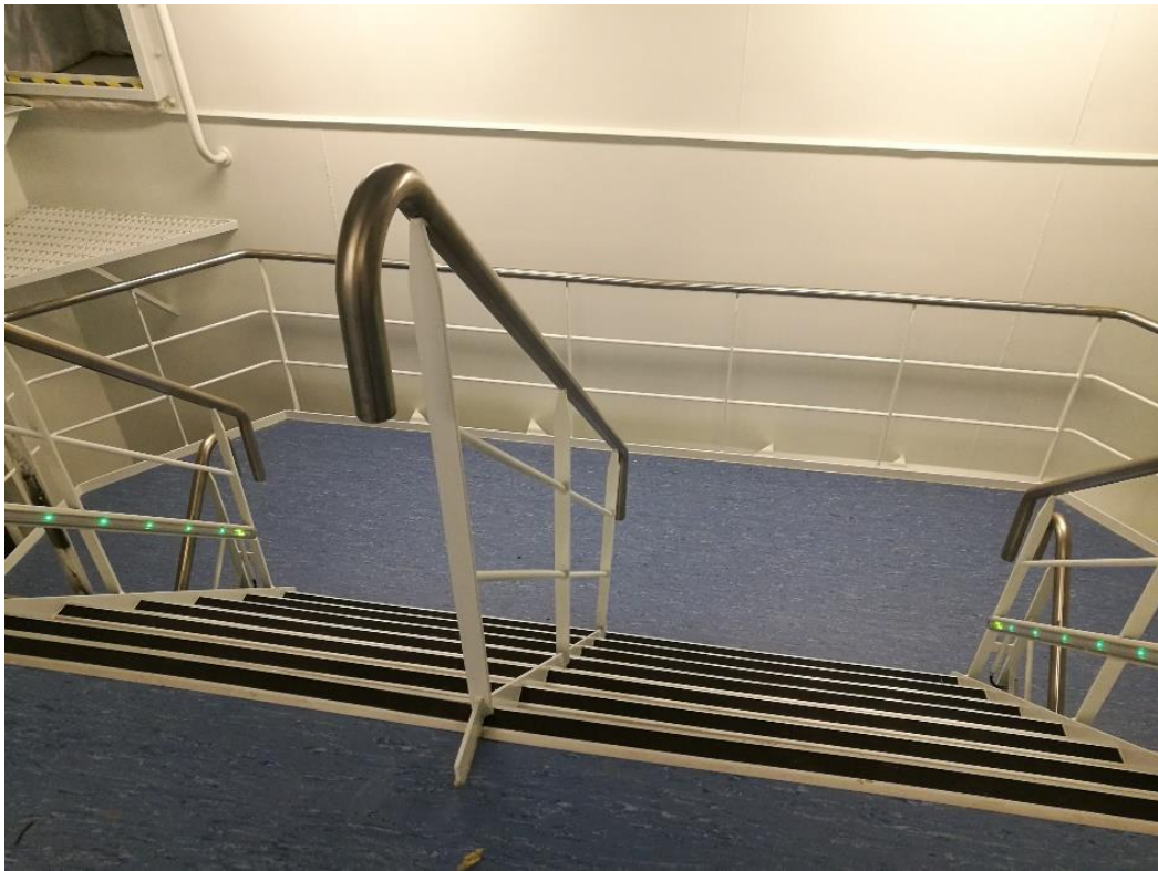
Kuva 12. Osittain vuorattu miehistöportaikko.
