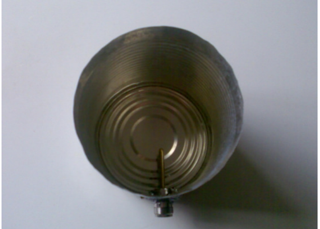
Kuva 12. Aaltoputkiantenni ilman suojakantta
