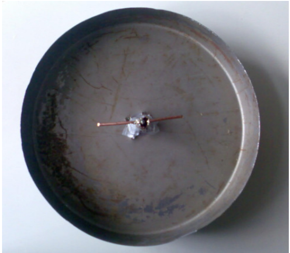
Kuva 14. Kakkuvuoka-antenni ilman suojakupua
