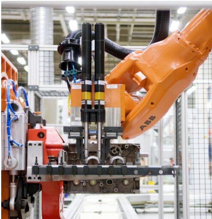
Kuva 23. Sähköiset mutterinvääntimet ABB robotin tarttujassa /26/.
