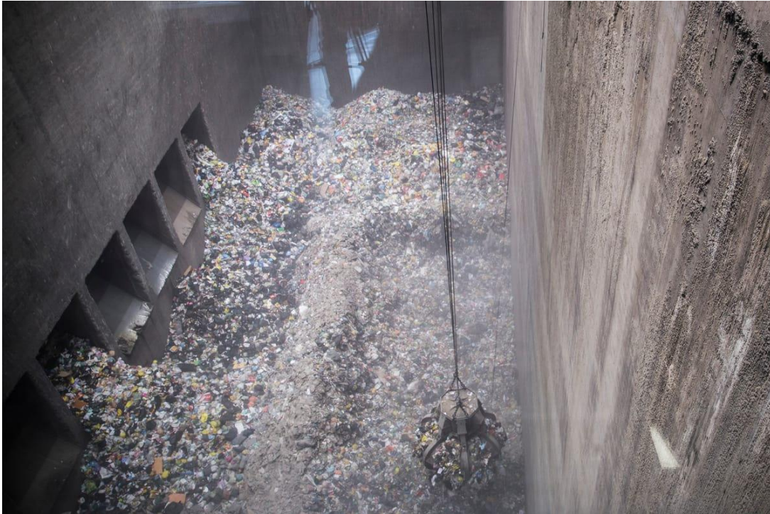
Figur 6 Bild från insidan av förbränningsverket i Vanda. Här samlas blandavfallet innan gripklon flyttar det till ugnen. Bild: YLE / Virtanen R. 2017.
