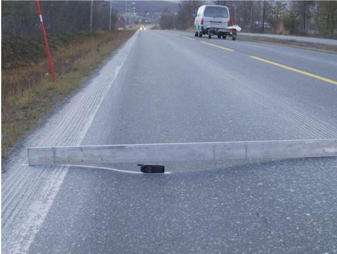
KUVA 2. Urasyvyyden mittaaminen oikolaudalla (8)
