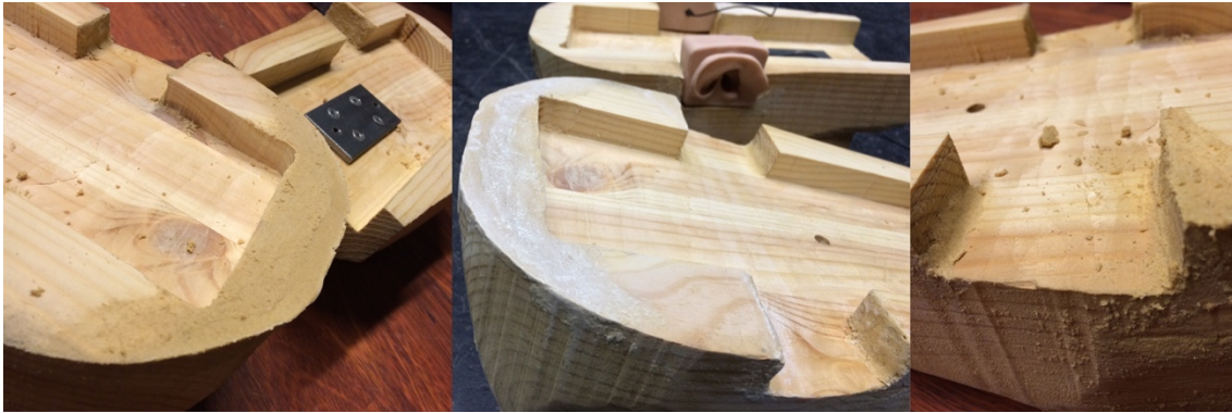
Figur 8. Version V2, isolering av skarv för att förhindra bl.a. läckage rakt igenom huvudet.
