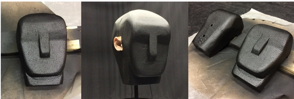
Figur 17. Version V5, mannequimmikrofonen ytbehandlat med gummimassa Dinitrol 447 Protect Super.
