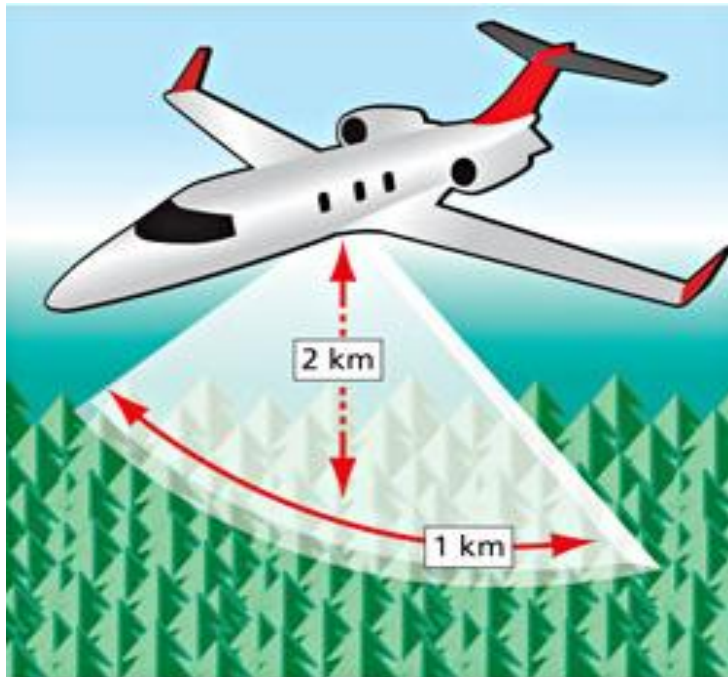
Kuva 1. Laserkeilainmittauksen periaate (Pihlava 2008.)
