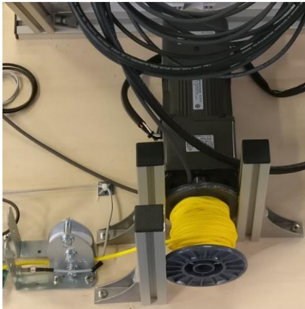
Kuva 16. Sähkömoottori ja siihen kiinnitetty kela ja vetonaru keskittimineen.
