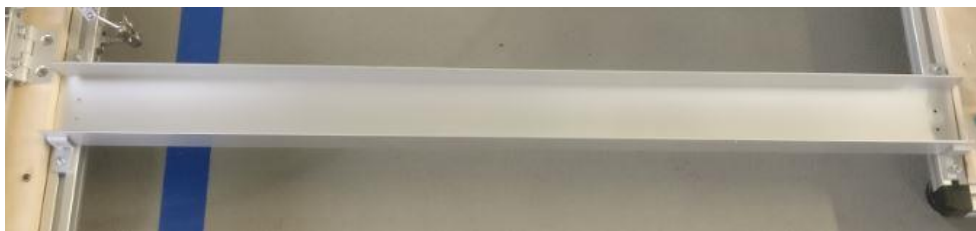
Kuva 18. Kiskosto kaapelin liikkuvuuden stabiloimiseksi.
