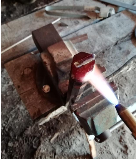
Kuva 4. Lämmittäminen juotoslämpötilaan happi-asetyleeniliekillä.
