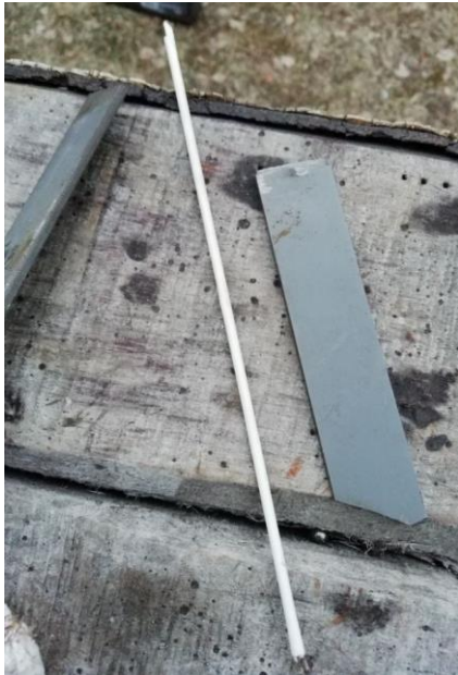
Kuva 1. Impoweld Ag 44 juotosaine ja kovametalli K20.
