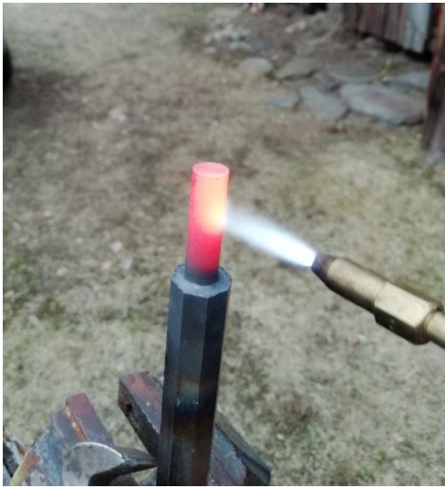
Kuva 5. Karapään lämmitys punahehkuun.
