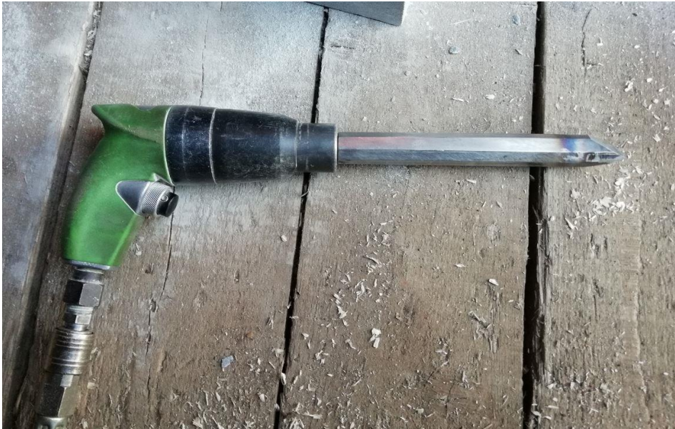
Kuva 8. Paineilmavasara ja talta.
