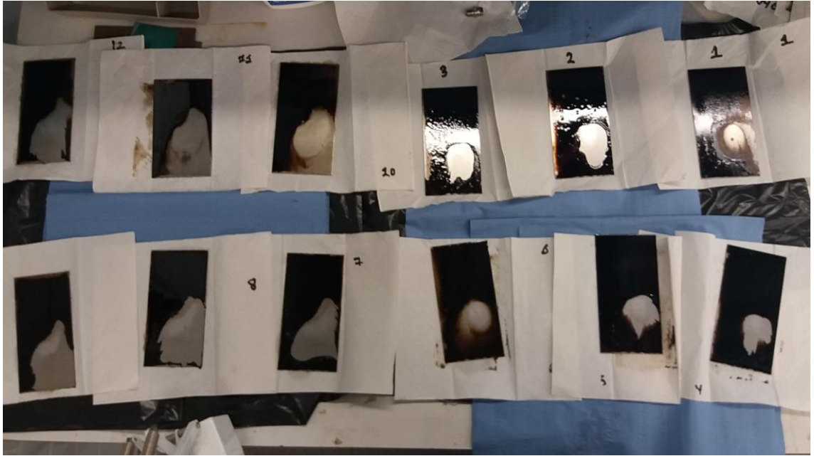
Kuva 39. Bitumikalvo kului vesisuihkun kohdalta. Levyt 1–6 oli testattu pistesuihkusuuttimella ja levyt 7–12 viuhkasuuttimilla.
