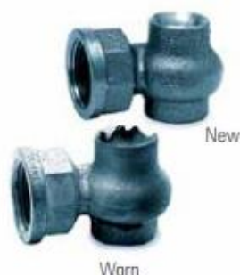
Kuva 23. Suutin on kulunut eroosion takia [12, s. 14.].
