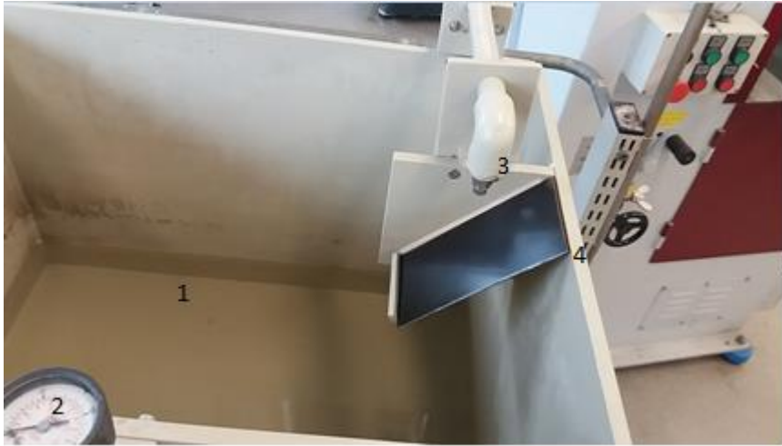
Kuva 36. Koelaitteen 1) vesiallas, 2) painemittari, 3) pistesuihkusuutin ja 4) koelevy.
