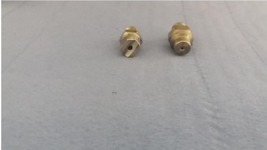
Kuva 33. Kokeeseen käytetty viuhkasuuttimen malli on HB1/8U- SS1520 (vas.) ja piste-suihkusuuttimen malli on B1/8MEG-0004 (oik.).
