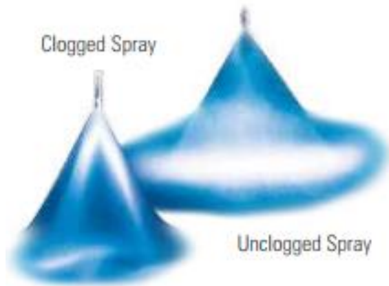
Kuva 28. Suuttimen tukkeutuminen vaikuttaa suihkun tasaisuuteen [12, s.14.].
