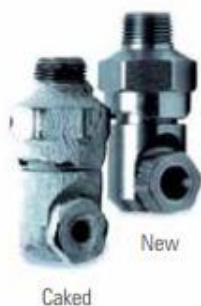
Kuva 26. Paakkuuntumisen takia reikä umpeutuu kiinni. Paakkuuntuminen näkyy suutinaukon ulkopuolella [12, s.14.].
