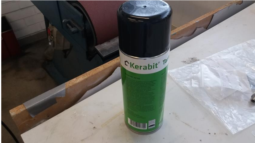
Kuva 31. Bitumispray sumutetaan puhtaan levyn pintaan.
