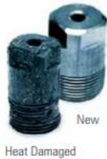
Kuva 25. Korkean lämpötilan aiheuttama suuttimen kuluminen [12, s. 14.].
