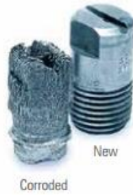
Kuva 24. Korroosion muodostuminen suuttimessa [12, s. 14.].
