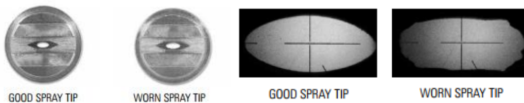
Kuva 21. Suuttimessa tapahtuneita muutoksia [12, s.16.].
