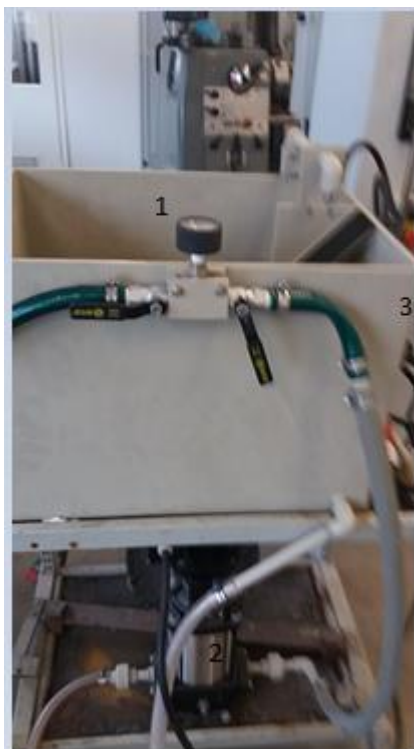
Kuva 37. Vedensuihkutuslaite. Laitteessa on 1) painemittari, 2) sähköpumppu ja 3) vesiallas.
