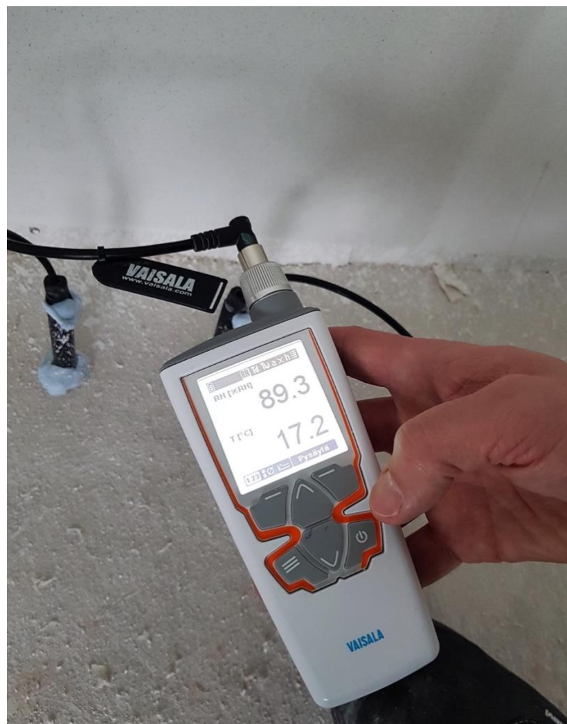
Kuva 16. Rakenteiden kosteusmittauslaite Vaisala SHM40. (YIT Rakennus Oy 2018).
