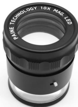
Kuva 8. Mittaluuppi vedeneristeen paksuuden mittaukseen. (Paine Technology 2018.)
