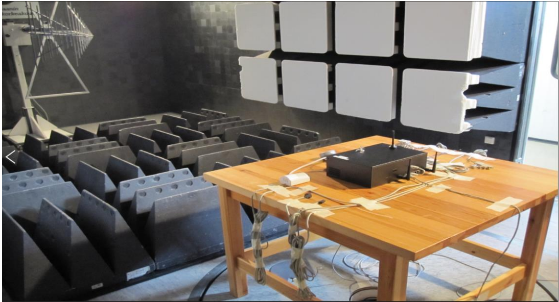
Kuva 7. Säteilevien RF-häiriöiden emissiotestausten järjestely.
