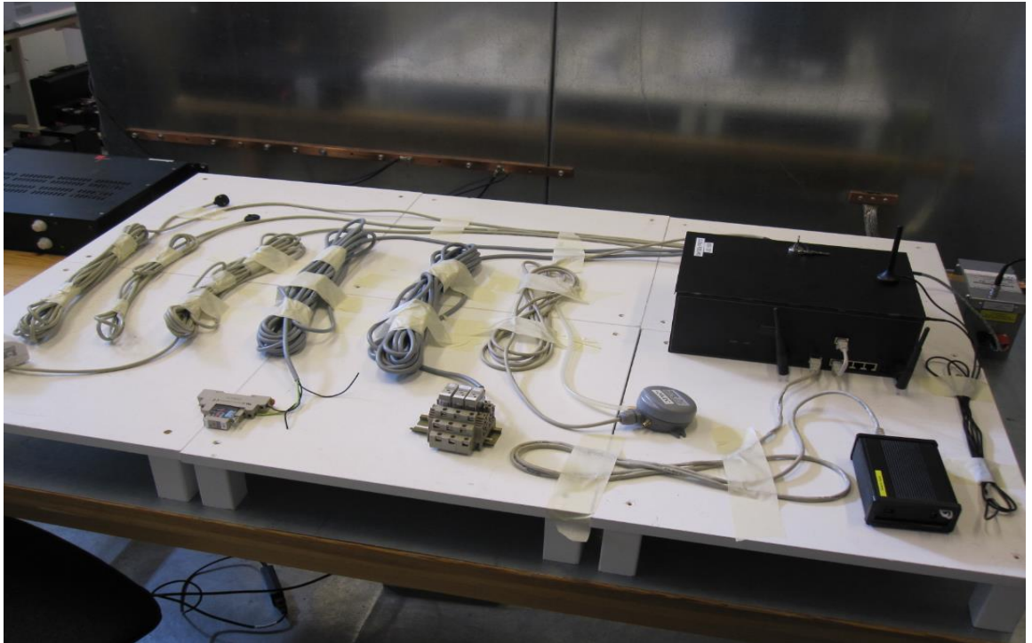
Kuva 14. Johtuvien RF-häiriöiden sietotestien järjestely
