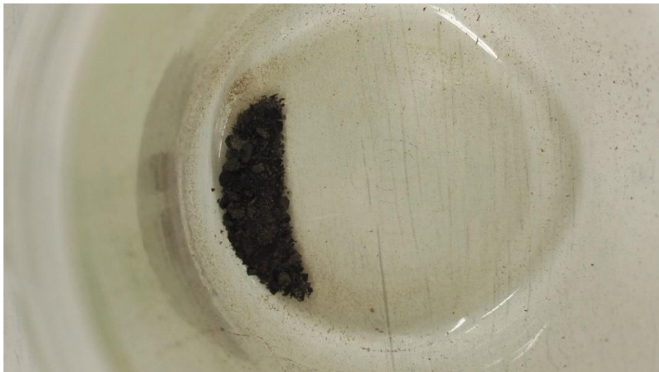
Kuva 12. Rejektiveden kokeesta syntyneitä mustaa sakkaa.
