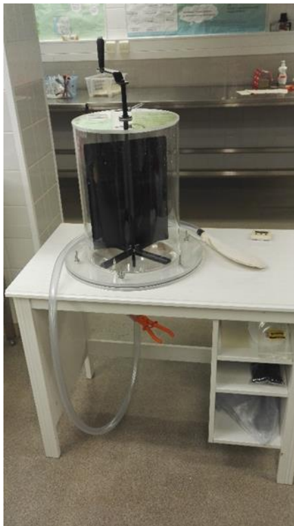
Kuva 3. Saostuslaitteisto muokkausten jälkeen.
