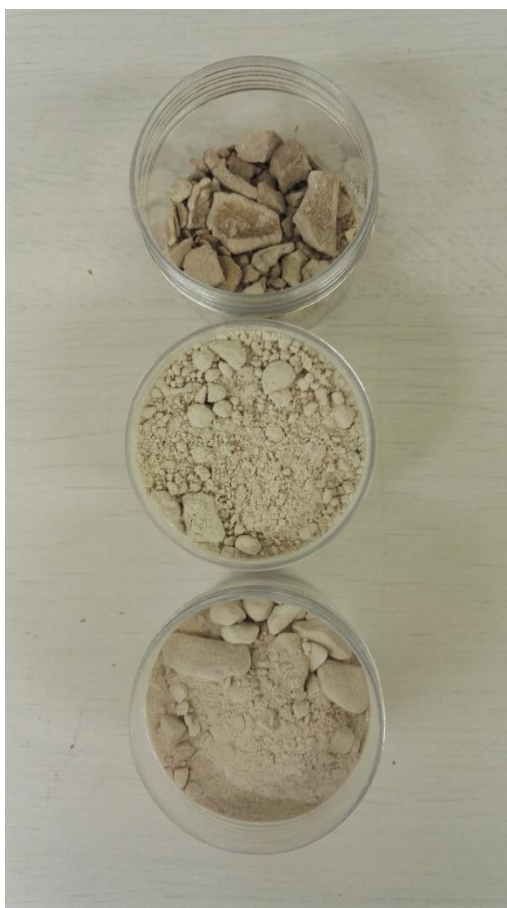
Kuva 11. Ylimmässä astiassa testivirtsan struviitti muutaman tunnin kuivatuksen jälkeen. Keskellä kuivatusaika virtsa 1 kokeen struviitille oli vuorokausi. Alimmainen struviitti oli uunissa noin 2–3 vuorokautta.
