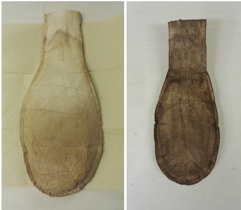
Kuva 20. Ensimmäisenä virtsan suodatinpussi kolmen kokeen jälkeen ja toisena rejektiveden suodatinpussi kahden kokeen jälkeen.
