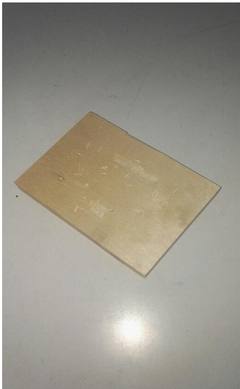
KUVA 3. Pintavirheellinen lankun pätkä
