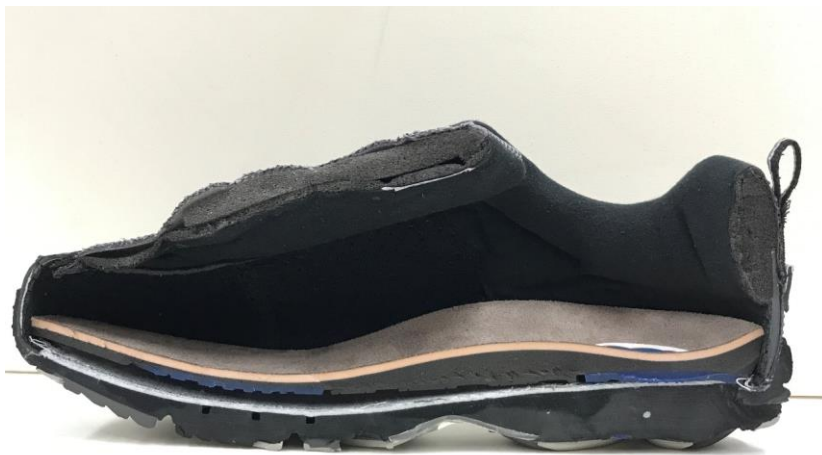
Kuva 9. Kengän läpileikkaus (Soile Kempainen 2017)
