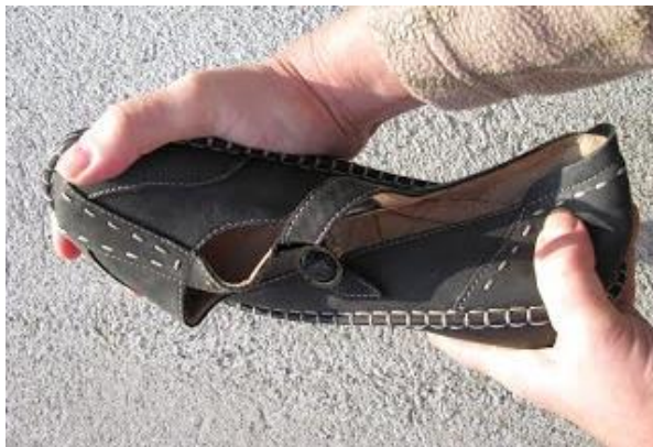
Kuva 29. Kengän kiertolöysyyden testaaminen (Jalkaterapiakeskus Ortoosi 2018)
