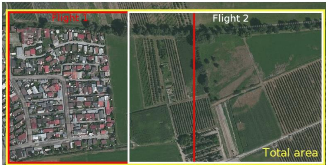
KUVA 3. Havainnekuva lentojen liittymisestä (Pix4dmapper user manual, 2017)
