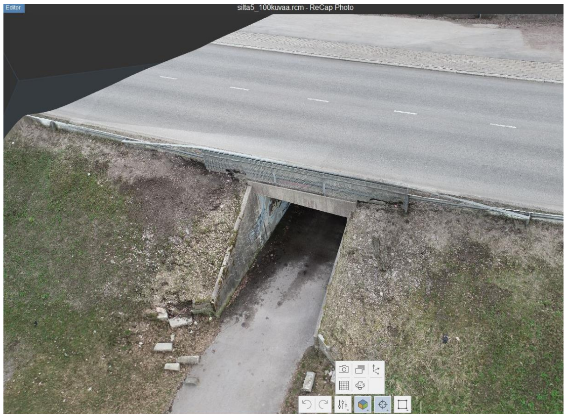
KUVA 32. Multikopterin kuvista tehty ulkopuolinen malli
