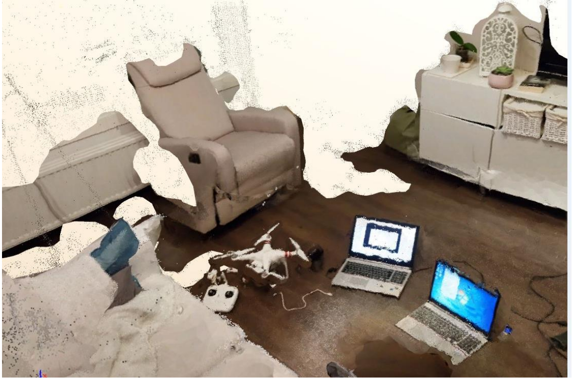
KUVA 23. Sisätilamallinnus Samsung S8+ puhelimella otetusta 4K videosta
