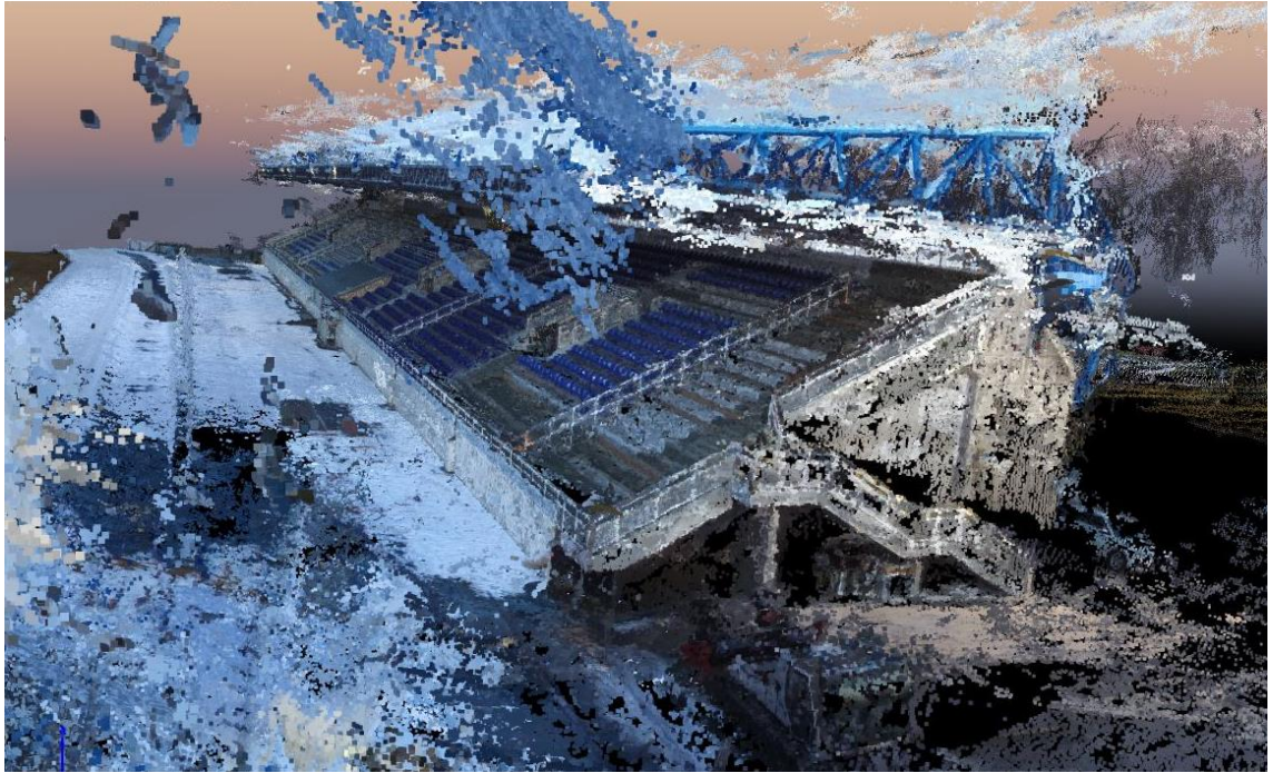
KUVA 20. Pix4d ohjelmalla mallinnettu katsomo, kohinaa
