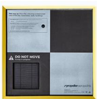
KUVA 34. Automatisoitu maatarkastuspiste (Aeropoints, 2018)
