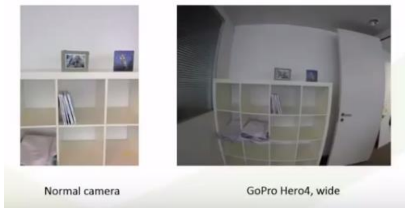
KUVA 24. Tavallinen ja kalansilmälinssi (Pix4D Webinar 14, 2014)
