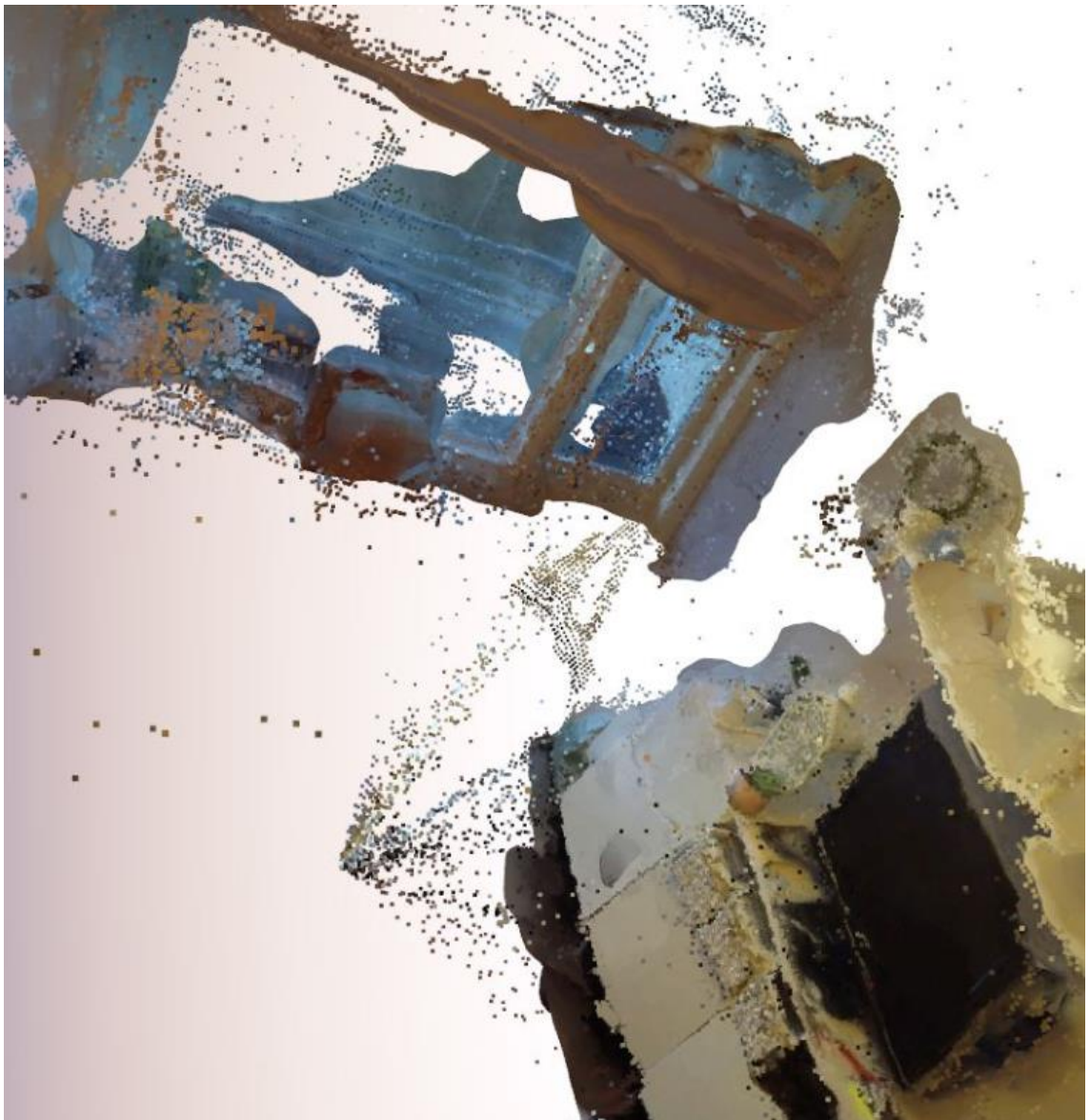
KUVA 22. Sisätilamallinnus heikkolaatuisesta videosta tehtynä Pix4d:llä
