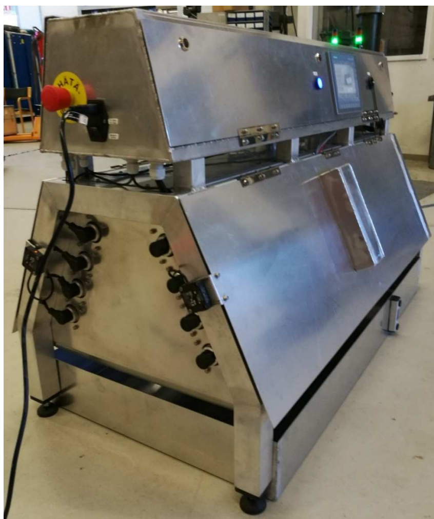
Kuva sähkökeskuksesta, hätä-seis-painikkeesta, suojaovesta ja ovirajasta
