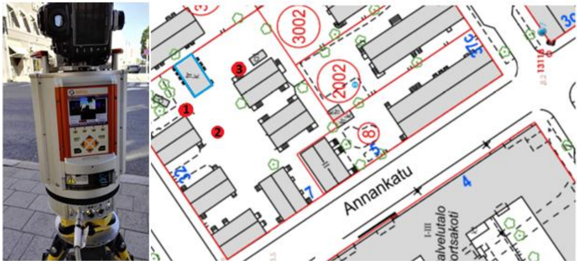
Kuva 27. Esimerkkikuva mittauksessa käytetystä Riegl VZ-1000 laserkeilaimesta ja mittausalueesta, jossa mittauskohteena sinisellä viivalla rajattuna piharakennus. Keilaimen aseointikohdat 1, 2 ja 3.[29]
