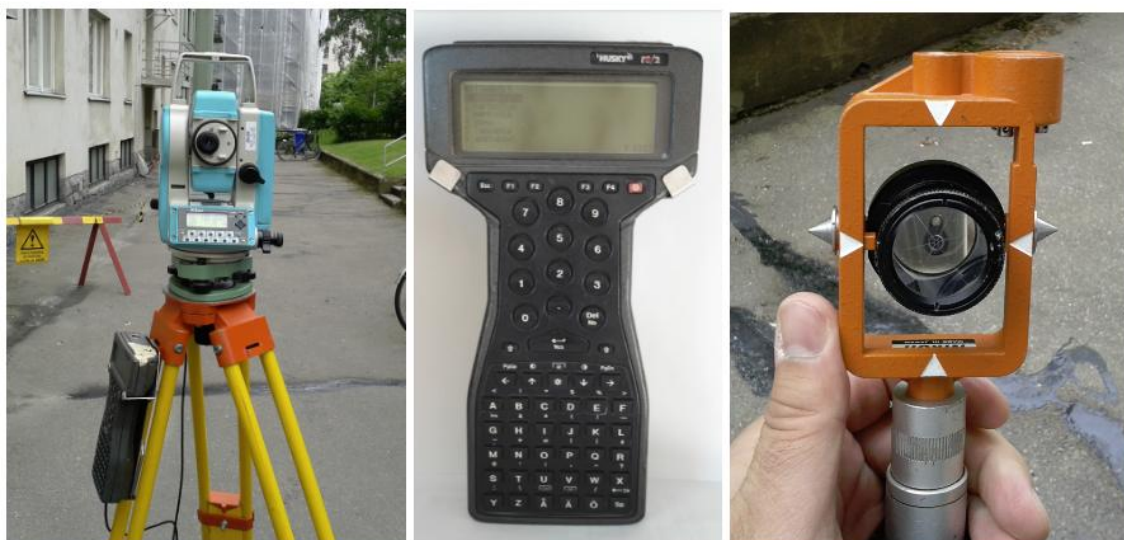
Kuva 21. Kuvassa Nikon NPL-350 -lasertakymetri kolmijalan päällä. Takymetriin on kytketty Husky FS/2 -maastonmittaustietokone keskellä. Oikealla olevassa kuvassa prisma, jossa säädettävä teleskooppisauva.
