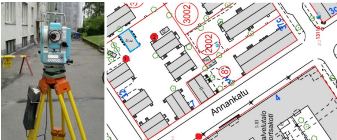
Kuva 25. Esimerkkikuva NPL-350 -takymetristä ja mittausalueesta, jossa mittauskohde on sinisellä viivalla rajattuna piharakennus. Punaiset pallot ovat takymetrin mittausasemointi paikkoja. Sininen pallo oikeassa yläkulmassa on korkeuskiintopiste.[29]
