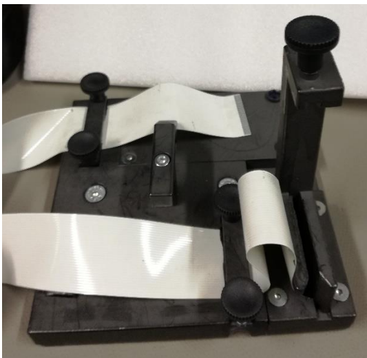
KUVA 16 Testausjigi ja siihen liitetty kaapelointi
