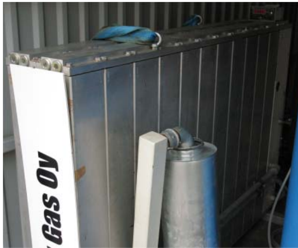
Kuva 37. Laser Gasin toimittama 11 x 2 generaattori sisältää 11 paria suodattimia.
