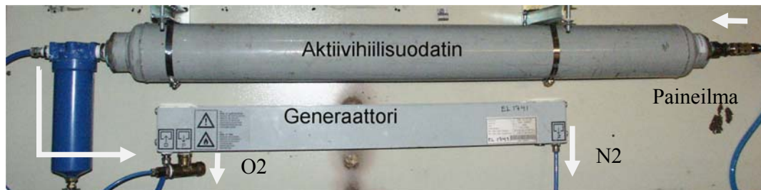
Kuva 44. Alhaalla on membraanigeneraattori ja ylhäällä paineilman aktiivihiihliuodatin (kuvassa asennettuna Turun ammattikorkeakoulun juotuskoneeseen).
