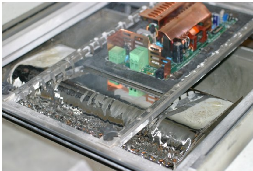
Kuva 7. Piirilevyn kulku juotoksessa
