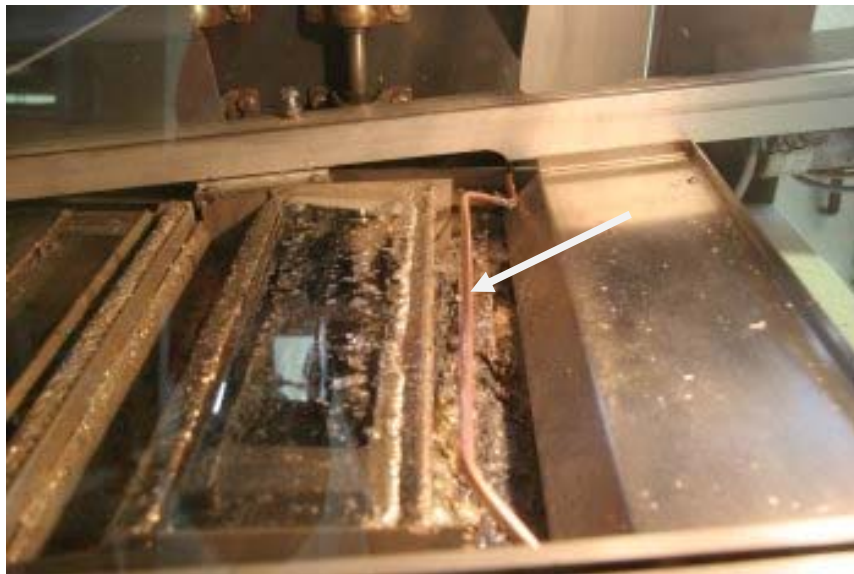
Kuva 42. Aallon eteen asennettiin kupariputkesta väännetty suutin kaasun syöttämiseksi.
