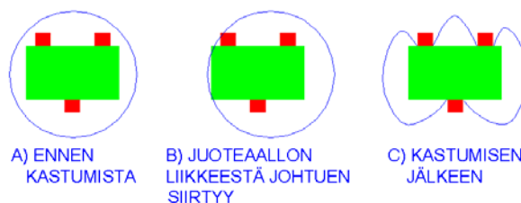
Kuva 2 Aallon pintajännityksen muodostama katvealue ylhäältä.
