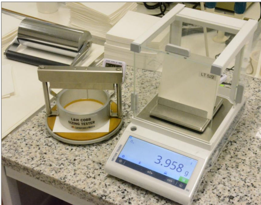
KUVA24. Veden absorbtion mittaaminen, Cobb-menetelmä
