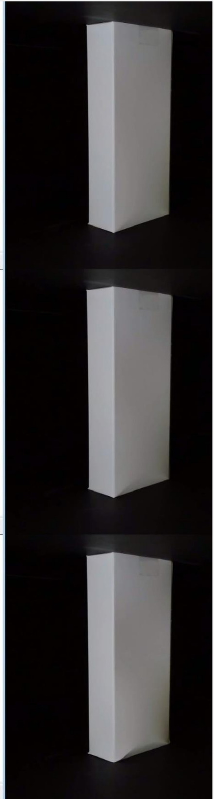
KUVA30. Näyttökuvat puristushetkestä, jolloin koteloon on syntynyt ensimmäinen vaurio tulkittuna videotallenteen, oman havainnoinnin sekä puristusvoimakuvaaajan perusteella.
