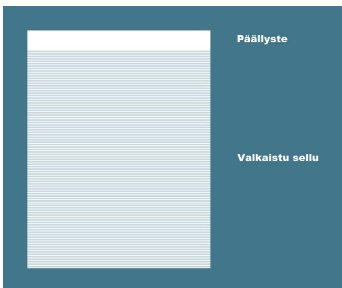
KUVA3. Sellukartongin rakenne (Iggesund 2010, 20 muokattu)
