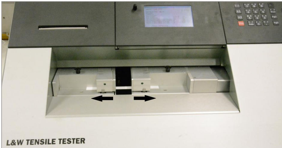
KUVA16. Tason suuntainen vetolujuuden mittalaite, L&W Tensile Tester
