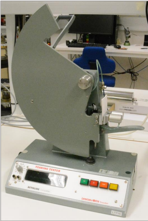
KUVA18. Repäisylujuuden mittalaite, L&W Tearing Tester
