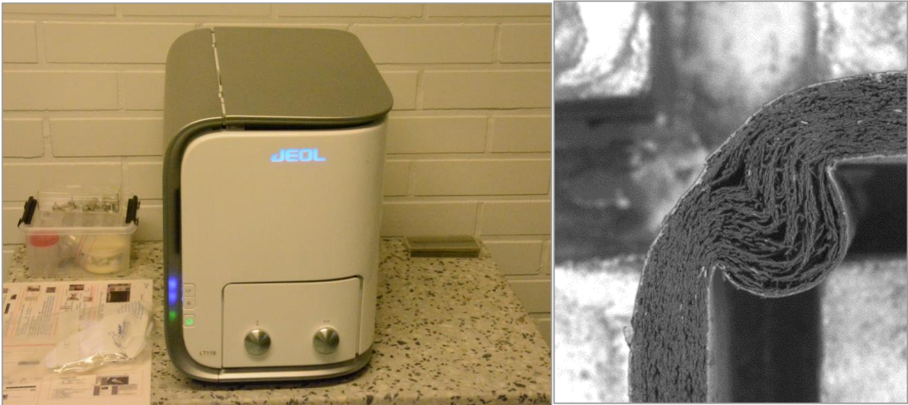
KUVA21. ESEM-mikroskopointilaite ja sen avulla otettu kuva nuuttisauman poikkileikkeestä
