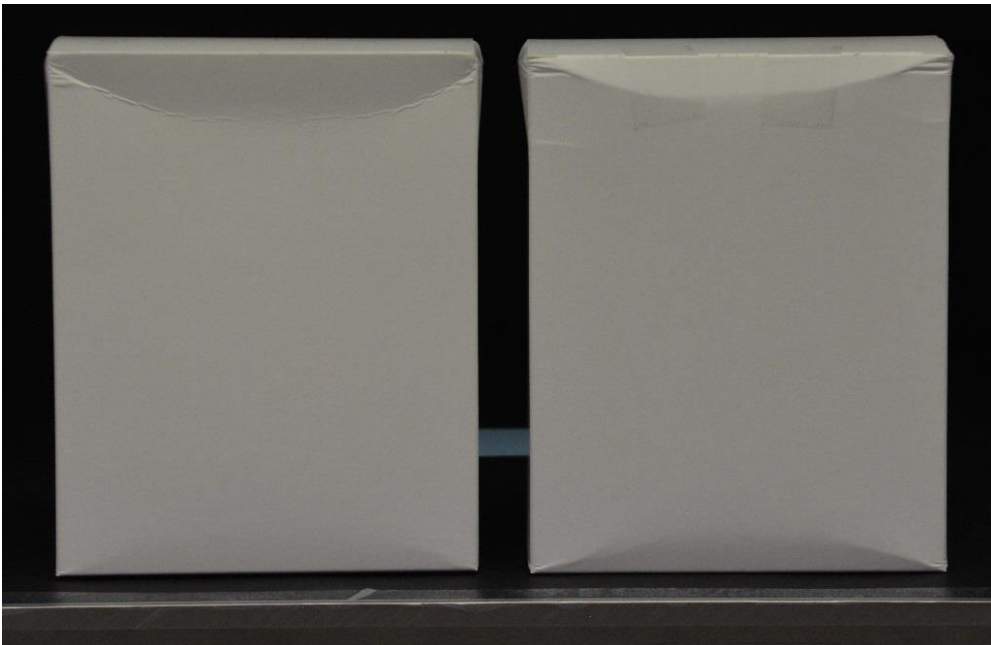
KUVA33. Teippaamattoman (vasen) ja teipatun (oikea) kotelon puristuminen eri tavoin
