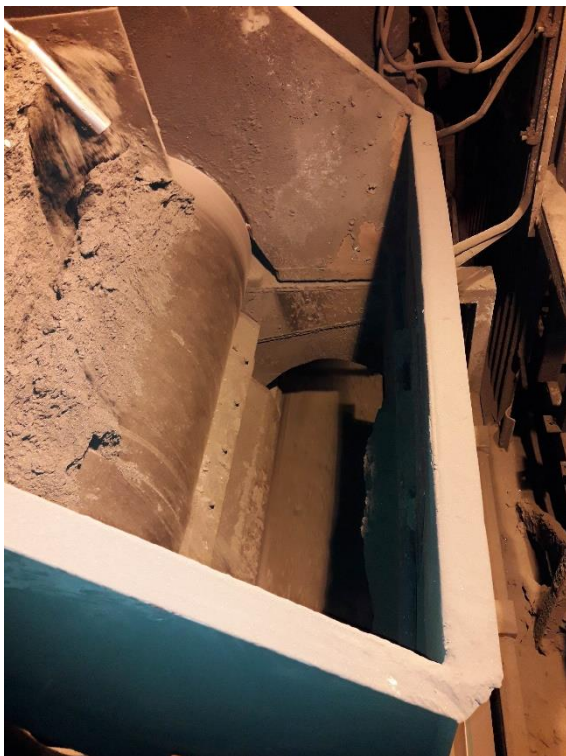
Kuva 2 Syötin pudottaa rikasteen kokoojahihnalle.
