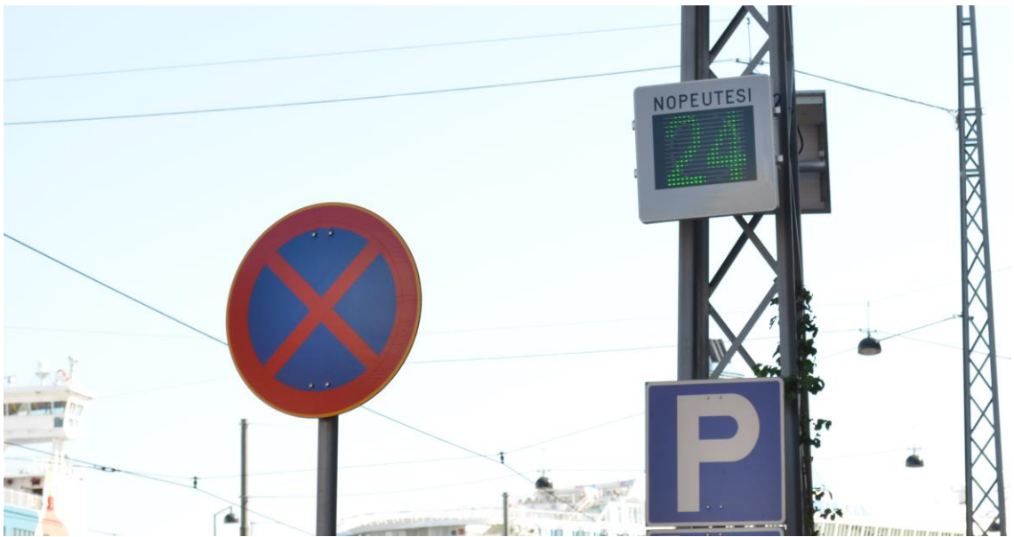
Kuva 5. Esimerkkikuva nopeusnäyttötaulusta. Taulu näyttää eri väreillä mitattavan ajoneuvon nopeuden sekä nopeuden mukaan vaihtuvan hymiön joka toimii palautteena ajonopeudesta.
