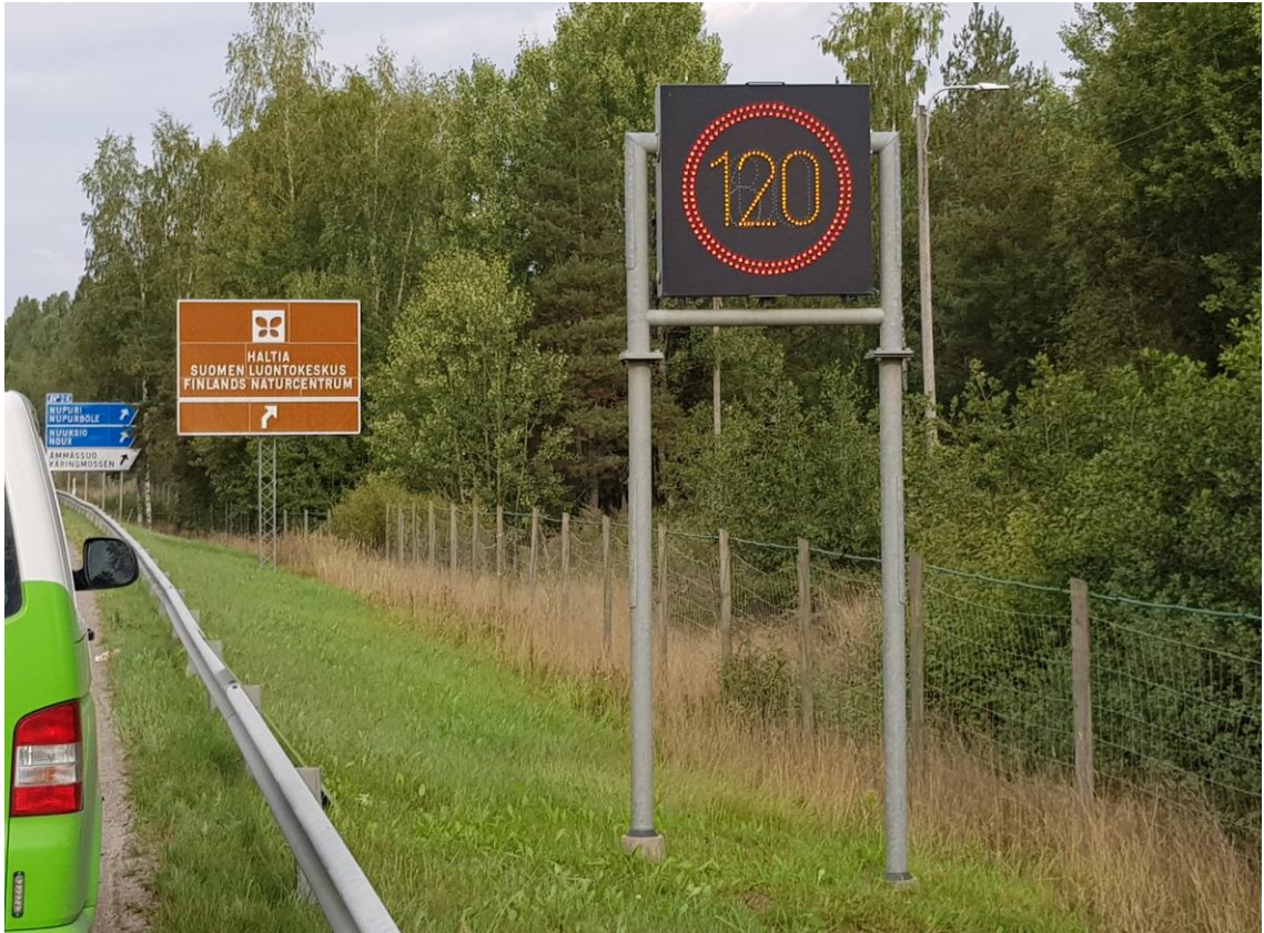
Kuva 1. Muuttuva nopeusrajoitusmerkki. Nopeusrajoitukset muuttuvat automaattisesti mm. sään mukaan.
