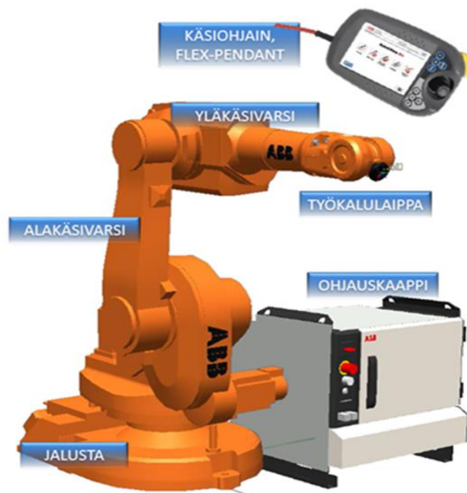
Kuva 12. Teollisuusrobotin järjestelmän osat /10/.
