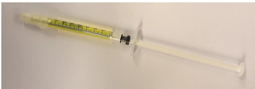
Kuva 12 Esimerkkikuva ~R100-GFP-silikahydrogeelistä petrifilmillä suljetussa 1 ml:n lääkeruiskussa
