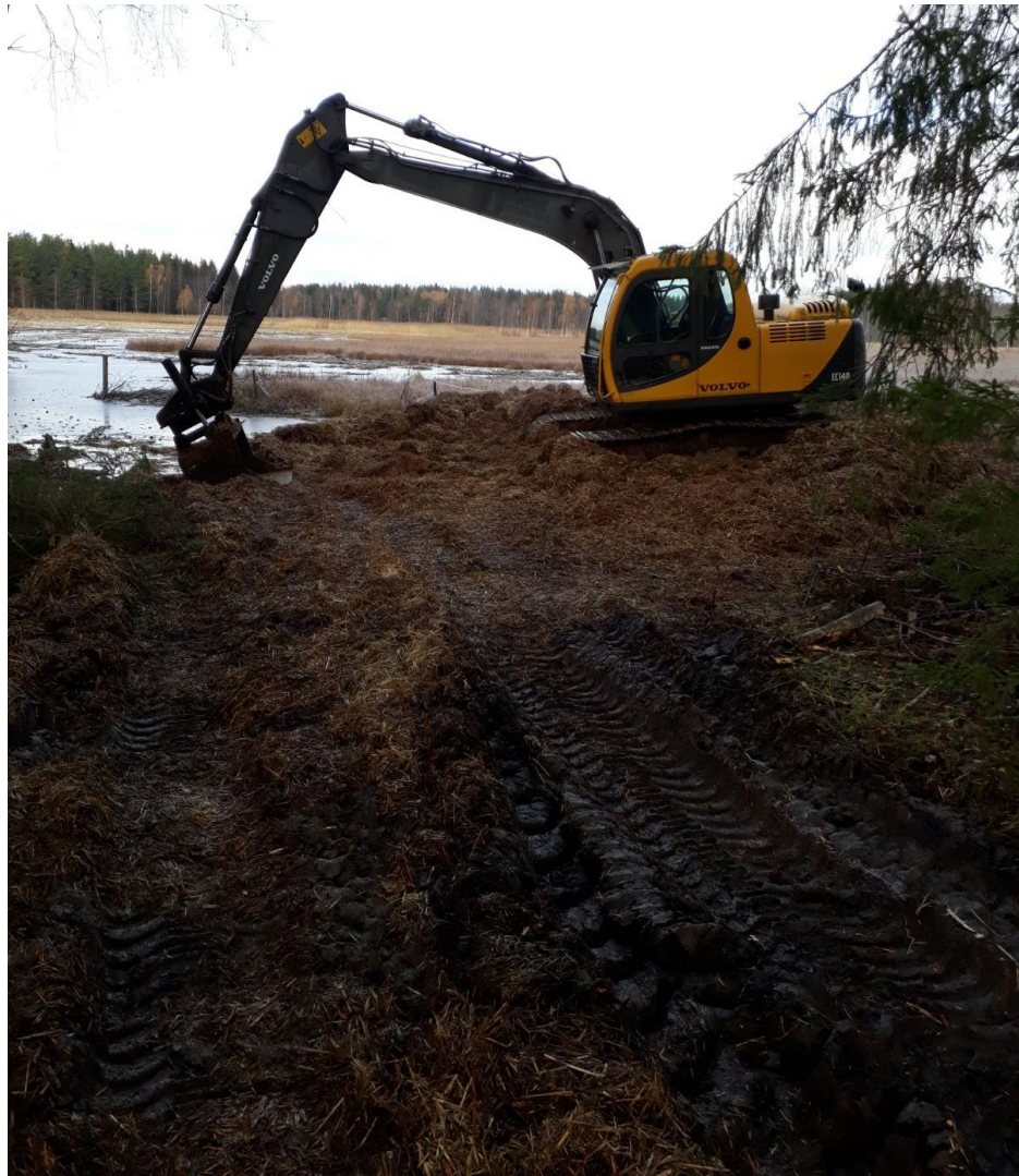
Kuva 8. Härkmerifjärdenissä ruoko varastoitii rantaan kuukauden ja 12 päivän ajaksi, josta se kuormattiin kaivinkoneella kärryihin ja vietiin pelloille. Välivarasto tehtiin liian lähelle rantaa, jossa riskinä ravinteiden valuminen takaisin vesistöön ja haittana vetelä pohja työkoneille. (Sjöstrand 2018.)
