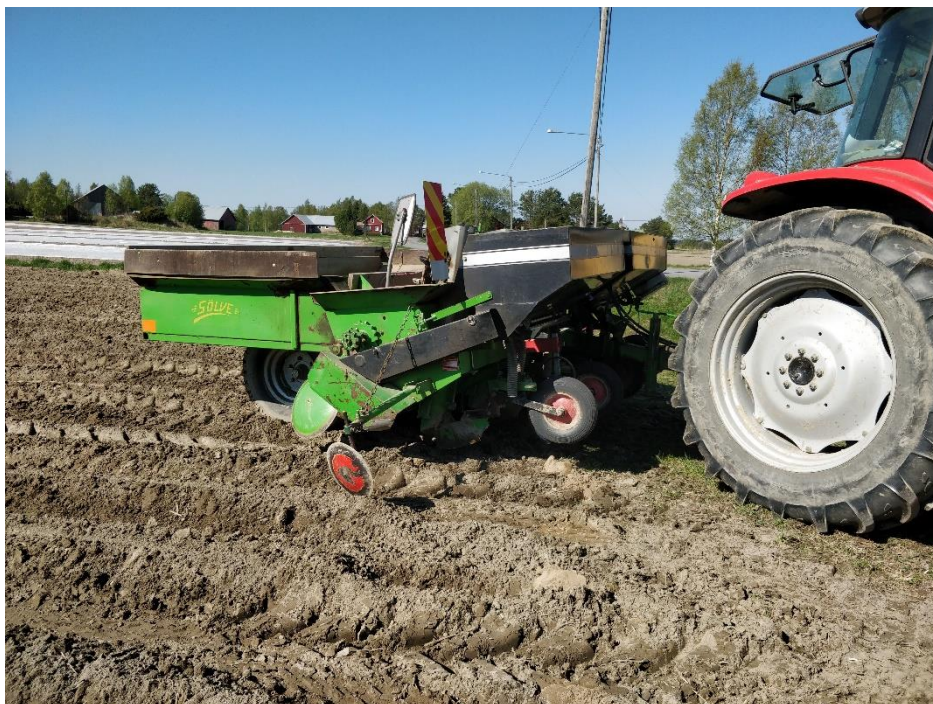
Kuva 19. Sekä ykkös- että kakkospellot istutettiin nelirivisellä hinattavalla perunanistutuskoneella. (Jaakkola 2018.)
