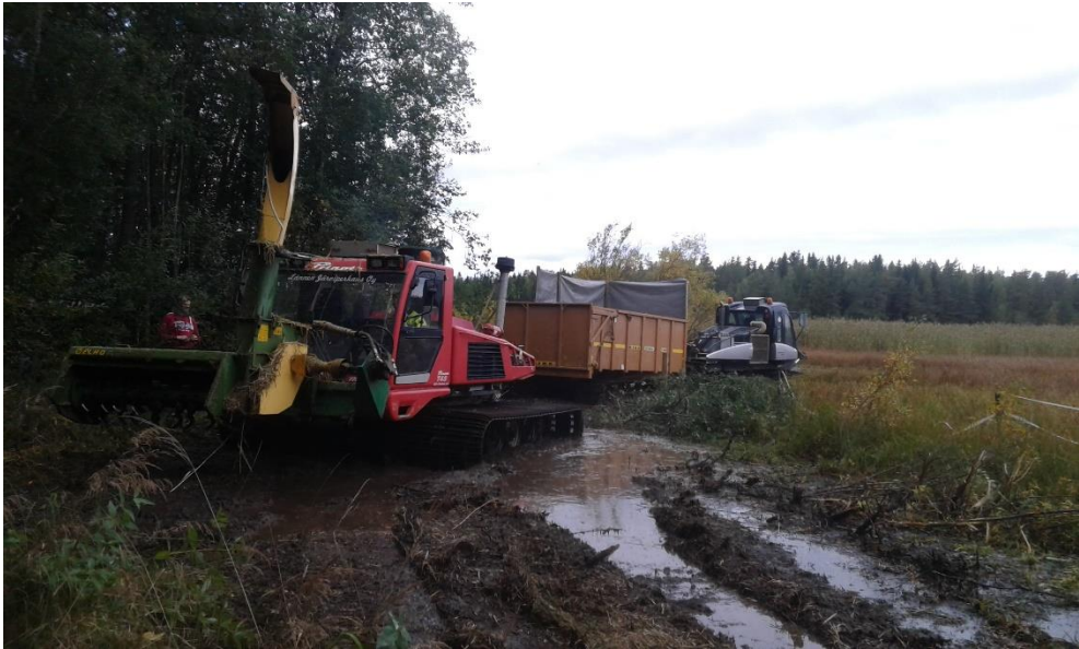
Kuva 6. Lännen Järviperkaus Oy suoritti niiton 18.9.2017 noin 16 tuntia 3,5 ha kokoiselta alueelta entisellä rinnekoneella, johon on kiinnitetty kaksoissilppuriyhdistelmä, joka leikkaa, silppuaa ja puhalttaa ruokoa. Ruokomassaa kertyi noin 500-600 m 3 . (Jaakkola 2018.)
