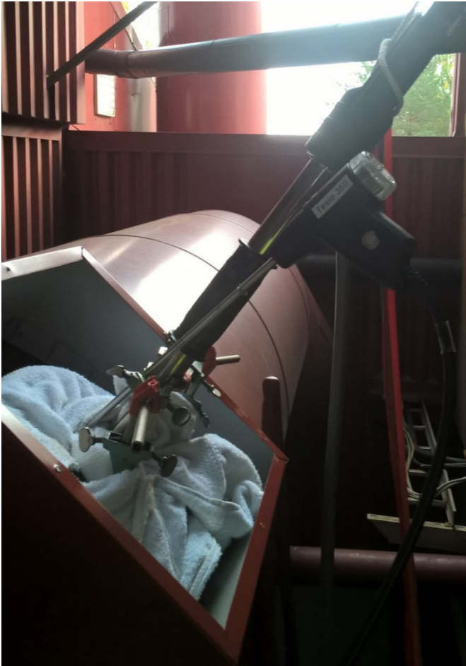
KUVA 3. Savukaasu- ja hiukkasmittaussondit savukaasukanavassa (kuva Riina Tuominen).
