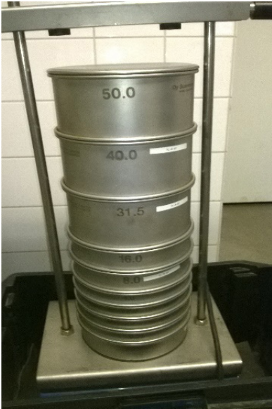
KUVA 3. Palakokojakauman määrityksessä käytetty täryseula (kuva Tarja Seppänen).
