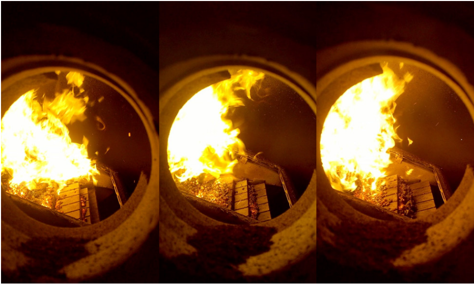
KUVA 10. Vasemmalla puupellettien poltto, keskellä hevosenlantakutteripelletti/puupellettiseoksen poltto ja oikealla hevosenlantaturvepelletti/puupellettiseoksen poltto Ariterm Oy:n BioComp 120 -kattilassa (kuva Riina Tuominen).
