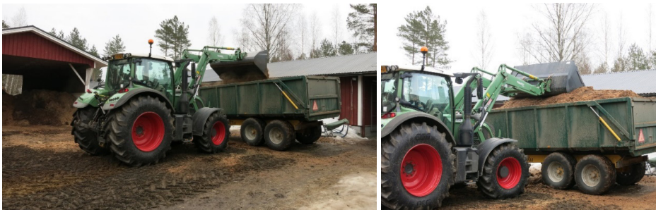
KUVAT 5 ja 6. Vasemmalla hevosennannan lastausta. Oikealla kuorman painelua kauhalla, jolloin siitä saadaan tiiviimpi ja pölyäminen vähenee siirtymän aikana (kuvat Jarno Föhr).
