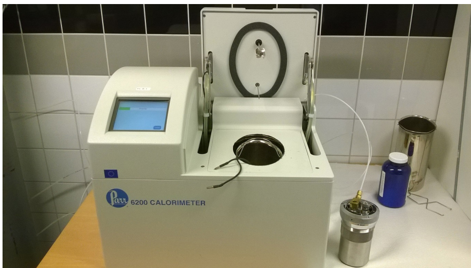
KUVA 5. Kalorimetriset lämpöarvot määritettiin Parr 6200 -laitteistolla (kuva Tarja Sepänen).
