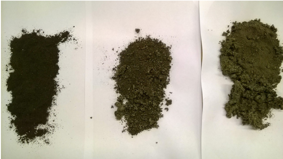
KUVA 9. Polttokokeissa syntyneitä tuhkia. Vasemmalla puupellettituhka, keskellä hevosenslantakutteri/puupellettituhka ja oikealla hevosenslantaturve/puupellettituhka (kuva Tarja Seppänen).
