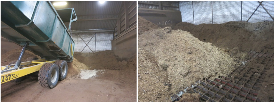
KUVAT 9 ja 10. Vasemmalla kuorman purkaminen kippaamalla. Oikealla kipattua hevoselantaa metallisen ritilälattian päällä (kuvat Jarno Föhr).
