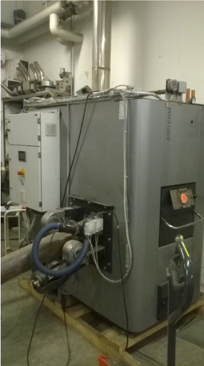
KUVA 1. Koepoltoissa käytetty BioComp 120 -kattila ja MultiJet 120 -poltin (kuva Tarja Seppänen).
