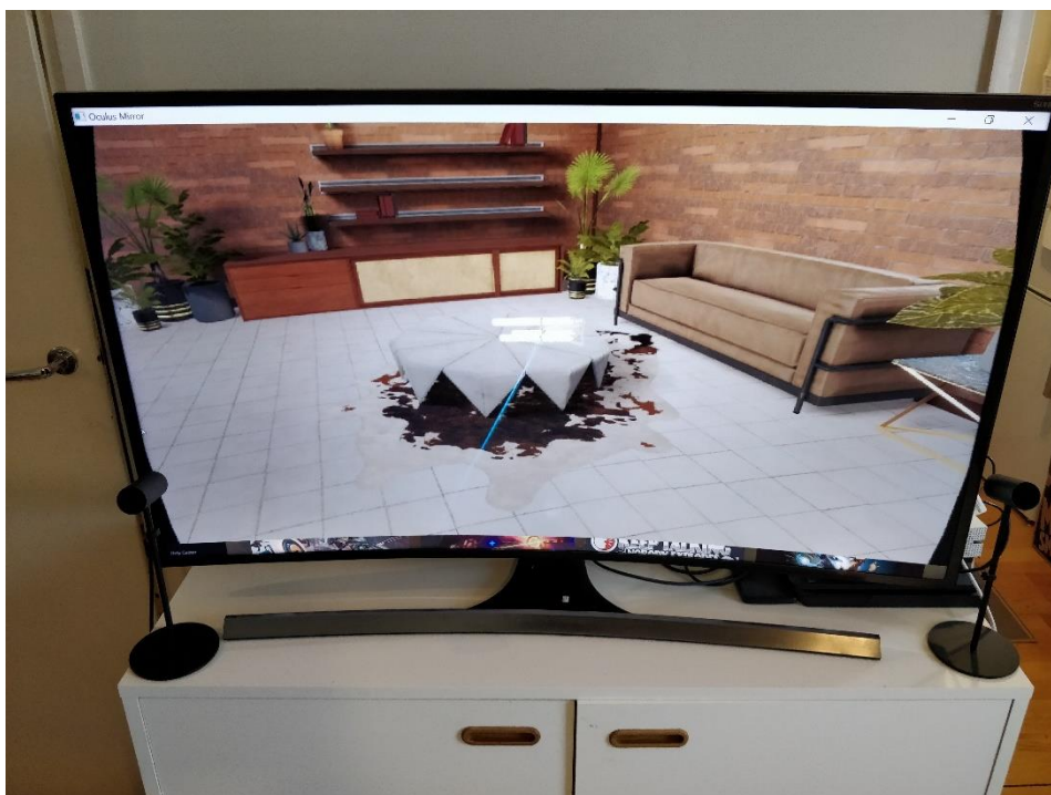
Kuva 5. Oculus Riftin liikkeenseuranta-anturit pöydän kulmissa.
