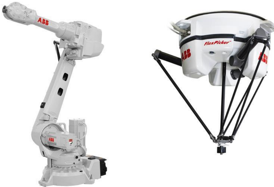
KUVIO 1. Avoimen ja suljetun kinemaattisen rakenteen robotit (ABB 2018)
